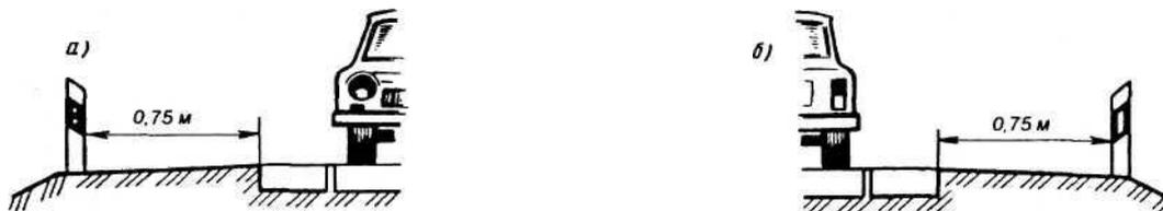
Рисунок 6.1. - Схемы размещения направляющих столбиков на дороге с левой (а) и правой (б) сторон
