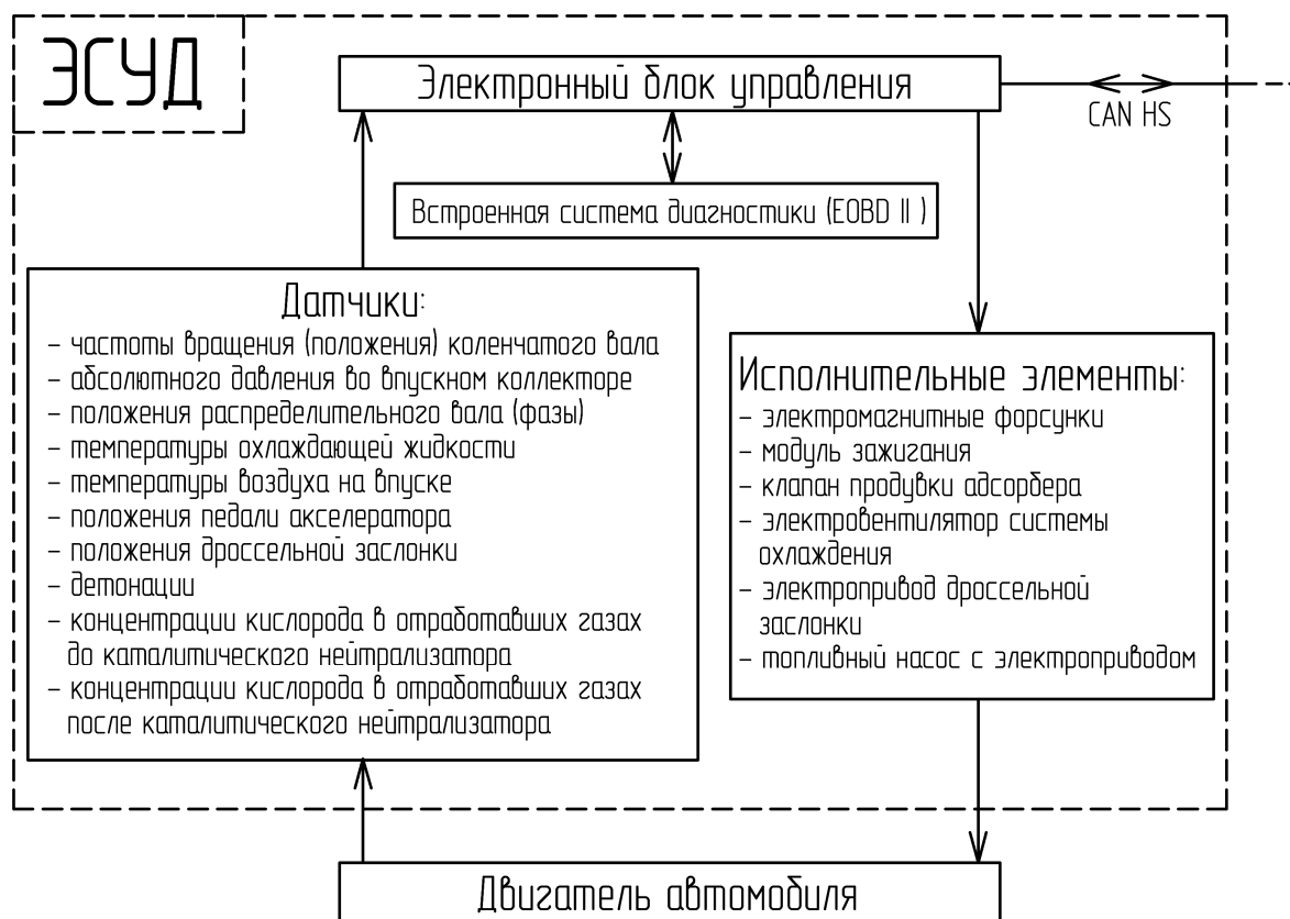
Рис. 1. Структурная схема ЭСУД BOSCH ME 7.4.4.
