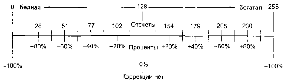
Рисунок 12.8 – Шкала коэффициентов топливкоррекции [26]
