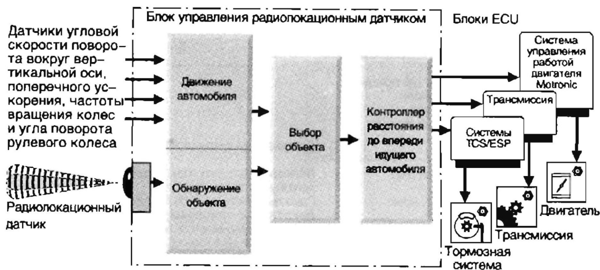
Рисунок 10.11 – Схема управления адаптивного круиз-контроля [1]
