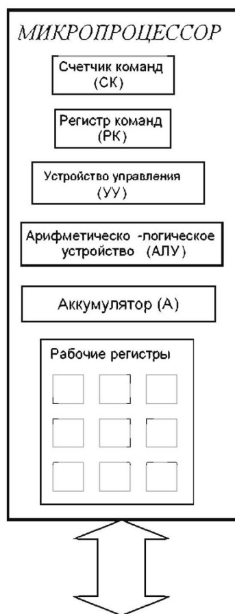
Рисунок 1.2 – Структурная схема микропроцессора
