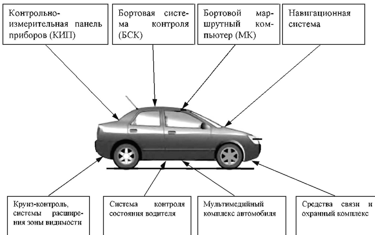
Рисунок 10.1 – Блок-схема информационной системы автомобиля
