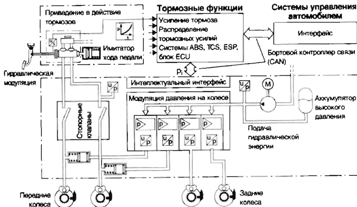
Рисунок 7.3 – Схема электрогидравлической тормозной системы (ЕНВ)
