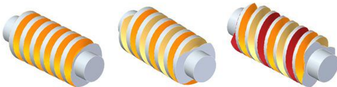
Рис. 6.1. Однозаходная и многозаходные резьбы
