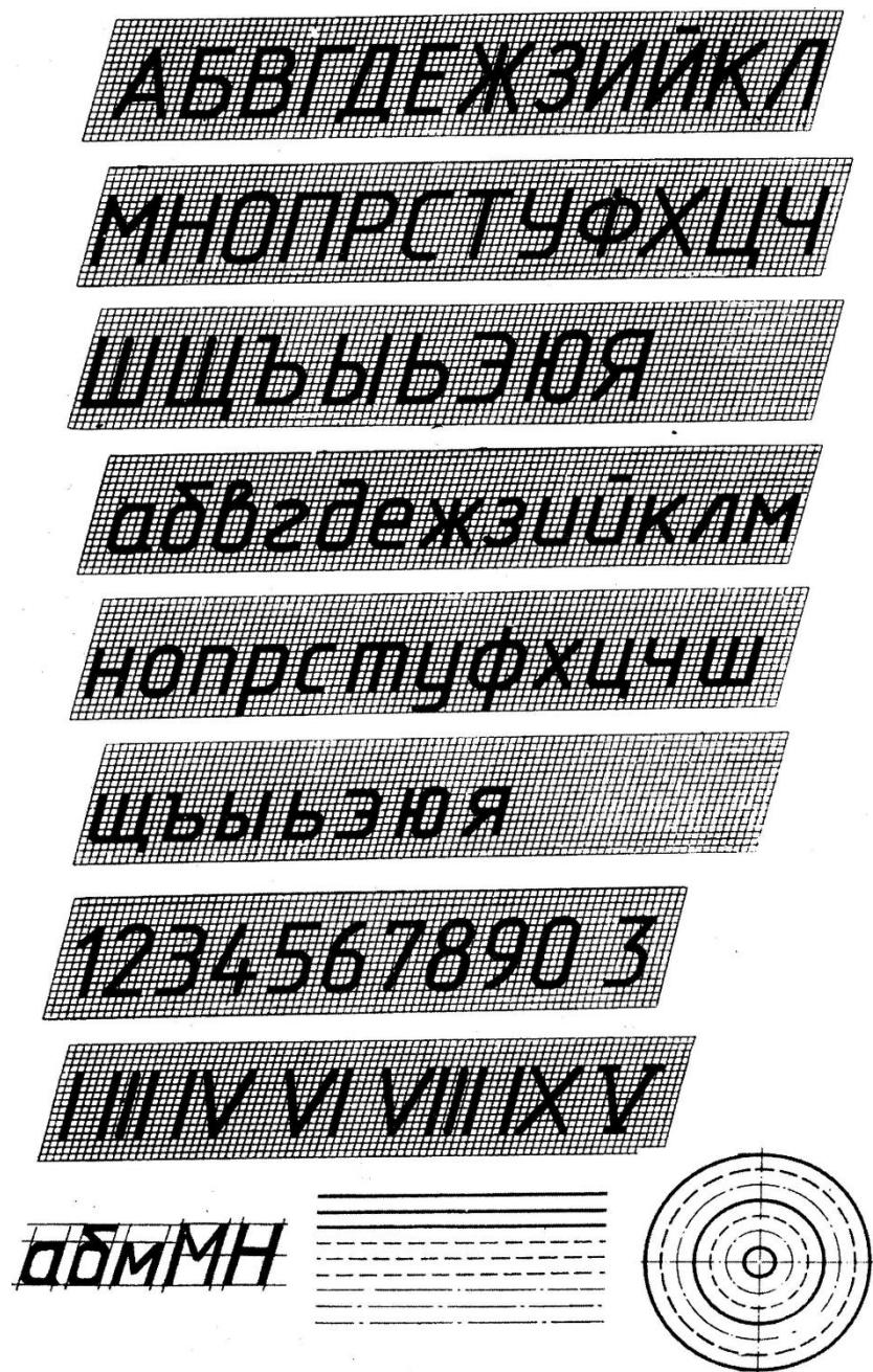
Рис. 3. Шрифты чертежные. Шрифт типа Б с наклоном
