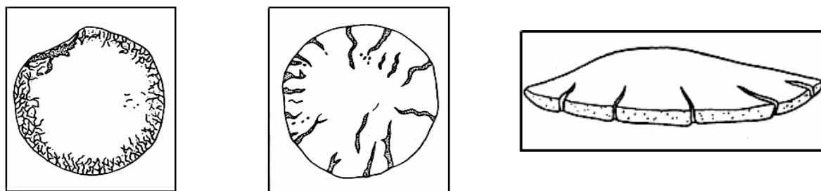
Рис. 7. Образцы, выдержавшие испытания на равномерность изменения объема: а) нормальное изменение объема; б) трещины усыхания
