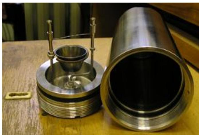
Рис. 3.2. Калориметрическая бомба в разобранном виде
