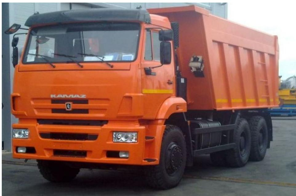
Рис. 14.2. Самосвал КамАЗ - 6520 грузоподъемностью 20 т,
