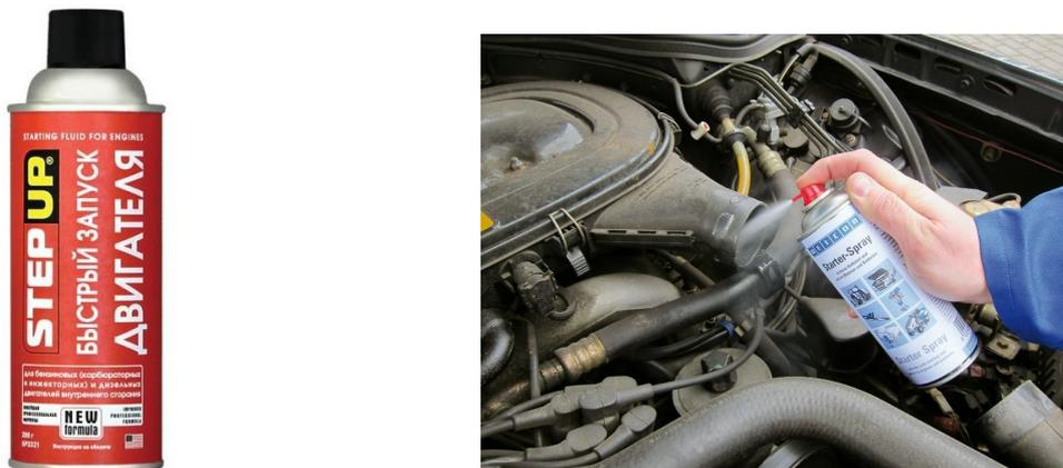
Рис. 12.5. Баллончик с пусковой жидкостью и его применение при запуске двигателя
