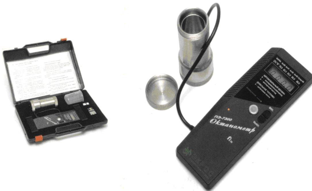
Рис. 6.3. Октанометр типа ПЭ-7300
