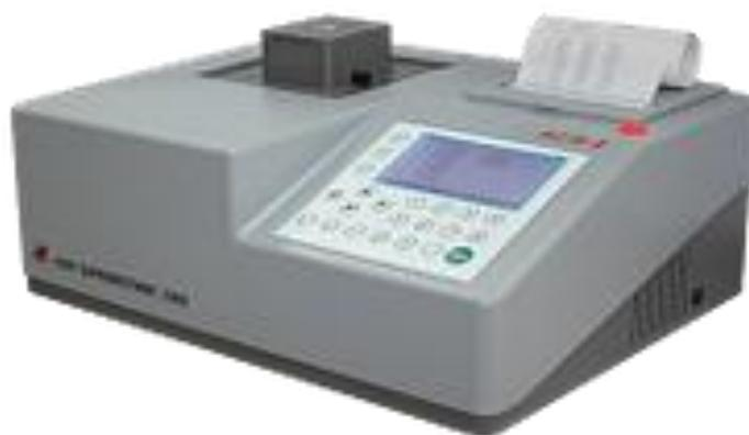
Рис. 4.1. Анализатор содержания серы в нефтепродуктах АСЭ-2
