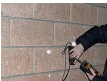
**Рис. 2.20. Определение наличия и шага раскладки арматуры неразрушающим методом**
