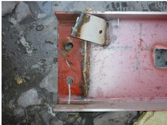
**Рис. 3.11. Повреждения из-за некачественно выполненных сварных соединений**
