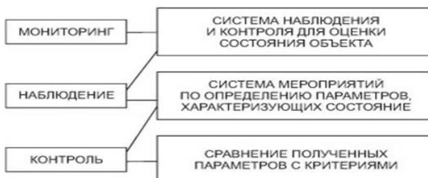
Рис. 7.1. Система мониторинга
