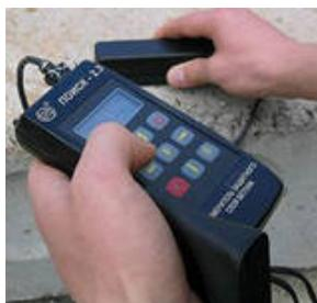
**Рис. 2.21. Определение диаметра арматуры в железобетонной конструкции**
