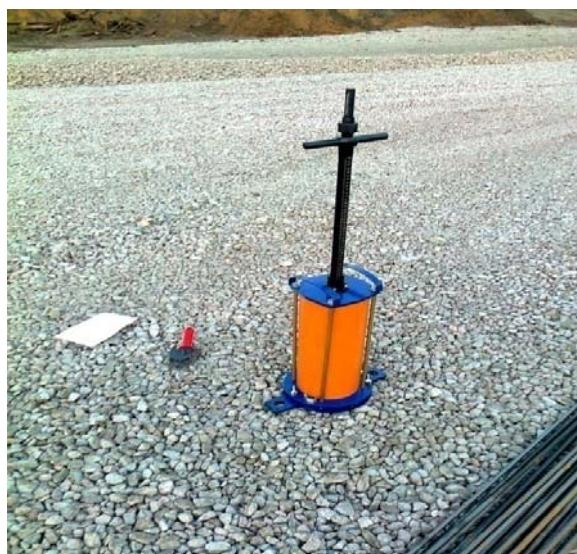
Рис. 2.25. Определение плотности основания из щебня
