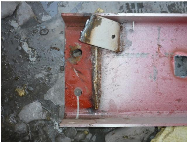
**Рис. 3.11. Повреждения из-за некачественно выполненных сварных соединений**
