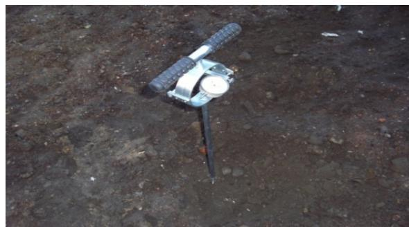
Рис. 2.24. Определение плотности основания из песка
