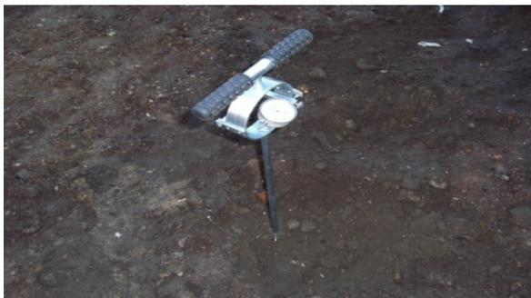
**Рис. 2.24. Определение плотности основания из песка**
