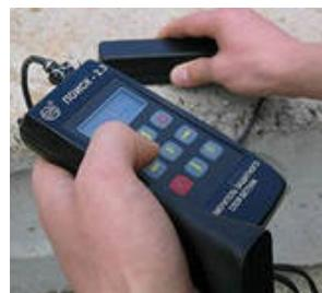
**Рис. 2.21. Определение диаметра арматуры в железобетонной конструкции**
