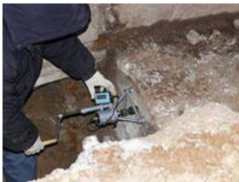
**Рис. 2.16. Определение прочности бетона методом отрыва со скалыванием**
