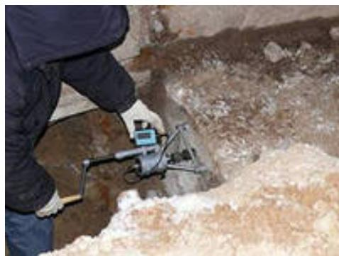
Рис. 2.16. Определение прочности бетона методом отрыва со скальванием
