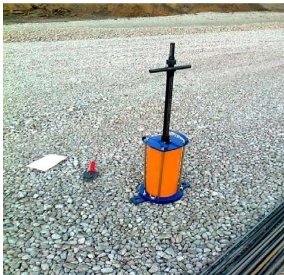
**Рис. 2.25. Определение плотности основания из щебня**
