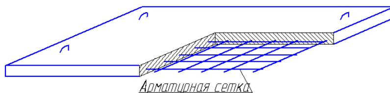
Рис. 2.124. Вид плиты перекрытия
