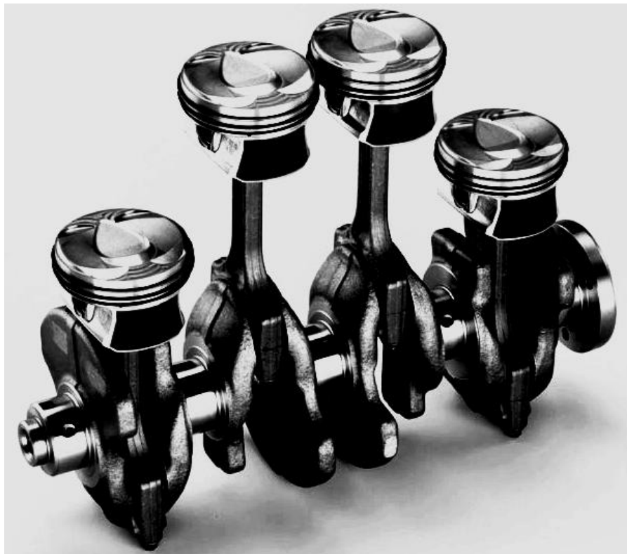
Рис. 2.4. Кривошипно-шатунный механизм (коленчатый вал, шатуны, поршни)
