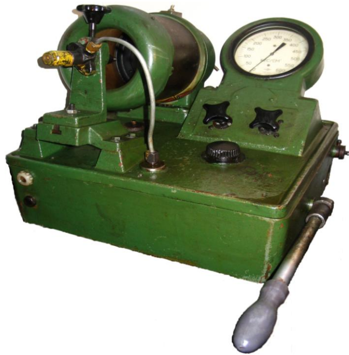
Рис. 2.2. Общий вид стенда КИ-3333 для регулировки форсунок
