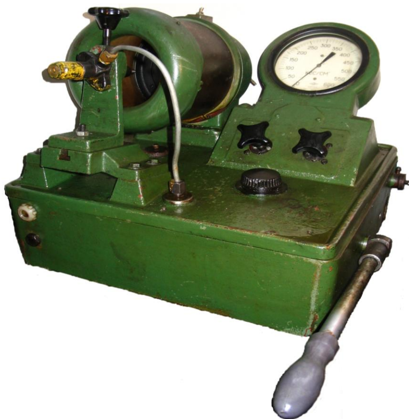
Рис. 4.2. Общий вид стенда КИ-3333 для регулировки форсунок
