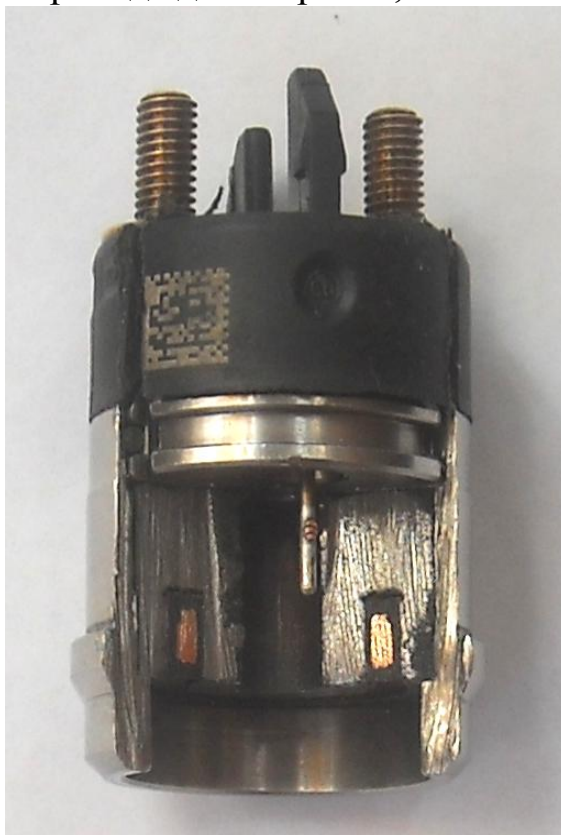
Рис. 6.14. Разрез катушки электромагнита
