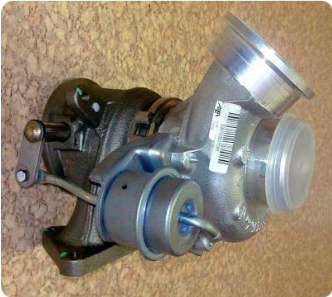
Рис. 8.11. Турбокомпрессор с системой перепуска части отработавших газов мимо турбины
