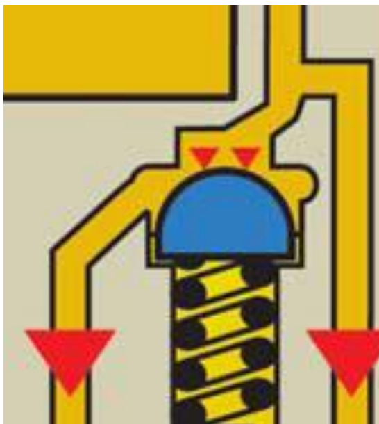
Рис. 1.31. Обратный клапан в открытом состоянии
