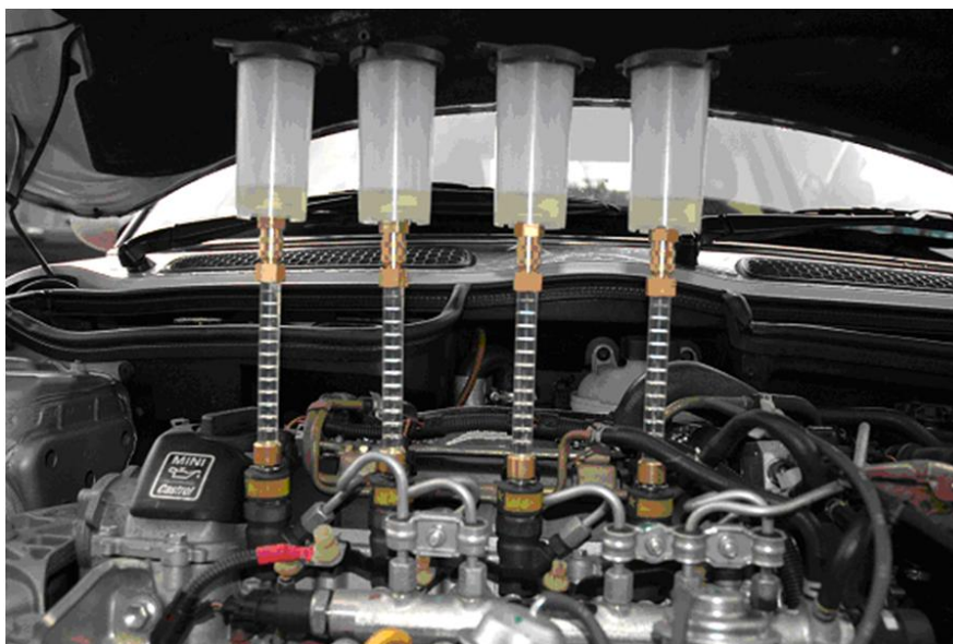
Рис. 6.15. Контроль сливаемого топлива из форсунок с электрогидравлическим управлением
