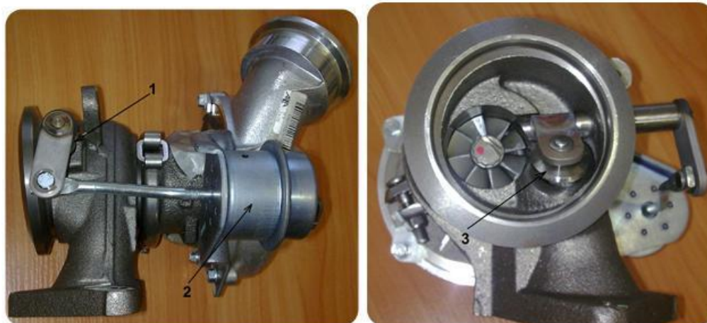
Рис. 11.1. Турбокомпрессор с перепускным устройством: 1 – рычаги управления заслонкой; 2 – пневматическая камера управления; 3 – заслонка
