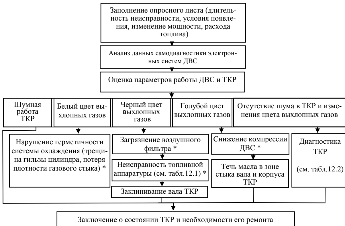
Рис. 12.2. Схема диагностирования систем ДВС и ТКР (*не связано с неисправностью ТКР)
