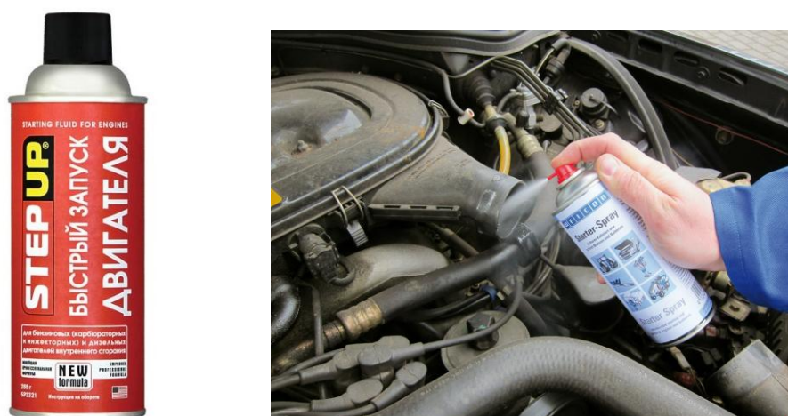
Рис. 12.5. Баллончик с пусковой жидкостью и его применение при запуске двигателя
