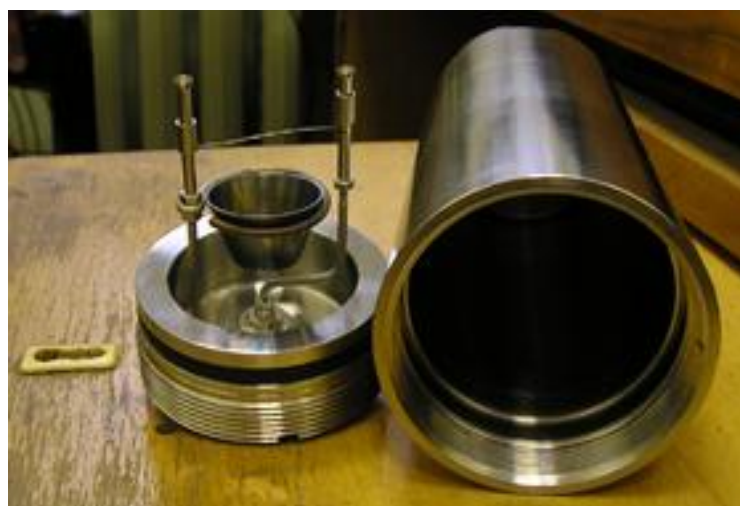
Рис. 3.2. Калориметрическая бомба в разобранном виде
