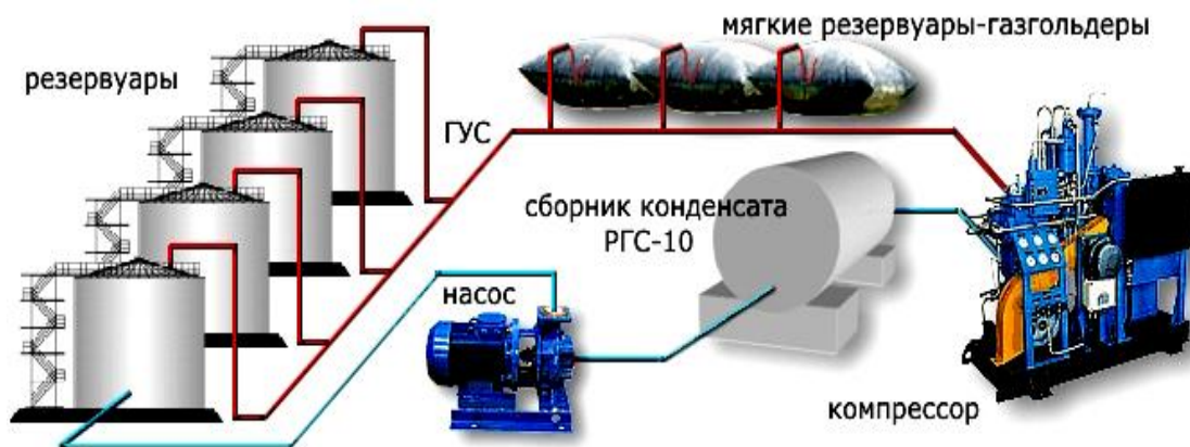
Рис. 16.4. Схема преобразования паровоздушной смеси в жидкость и ее возврат в резервуар
