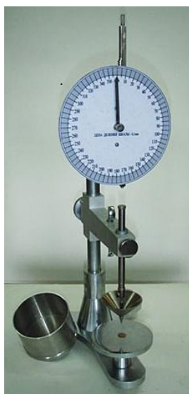
Рис. 10.1. Фото и рисунок пенетрометра:
