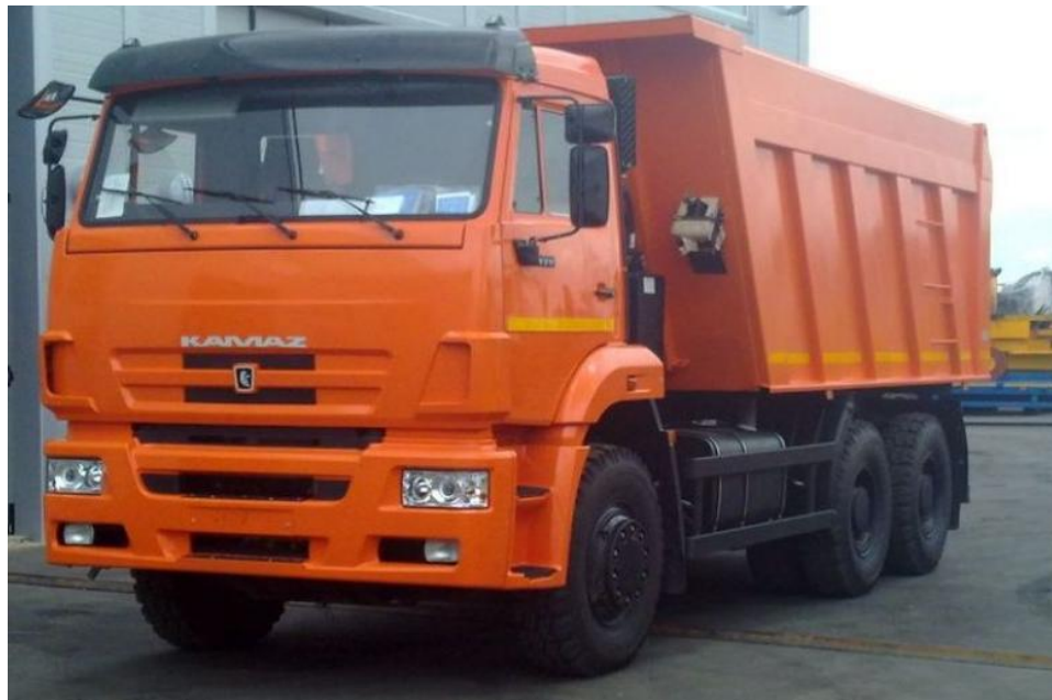
Рис. 14.2. Самосвал КамАЗ - 6520, грузоподъемностью 20 т, мощность двигателя 235 кВт
