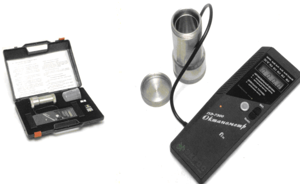
Рис. 6.3. Октанометр типа ПЭ-7300
