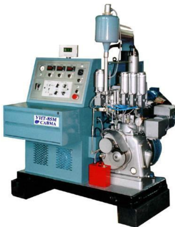
Рис. 6. 2. Общий вид установки УИТ-85М для определения октанового числа бензинов
