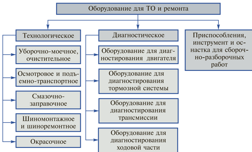
Рис. 4.1. Функциональное назначение оборудования для ТО и ремонта
