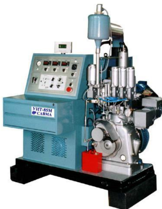
Рис. 4. 2. Общий вид установки УИТ-85М для определения октанового числа бензинов
