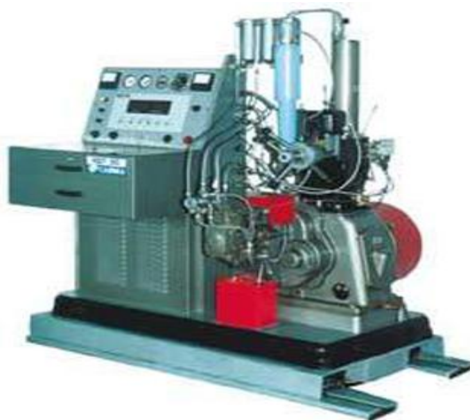
Рис. 4.5. Установка ИТД -90 для определения цетанового числа дизельного топлива
