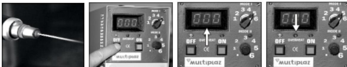
Рис. 4.10. Выключение горелки
