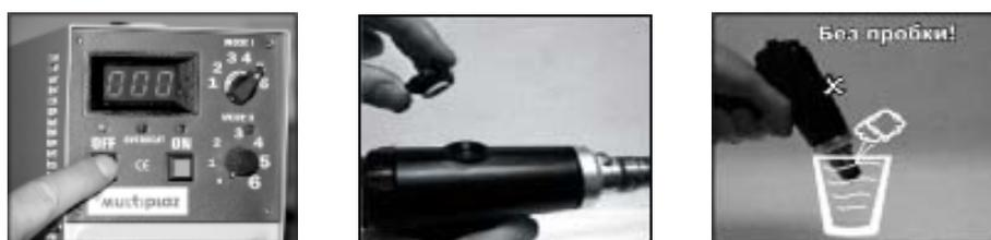
Рис. 4.9. Ускоренное охлаждение горелки
