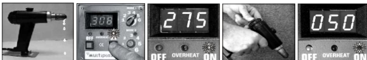
Рис. 4.7. Запуск горелки
