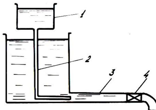
Рис. 4.1. Принципиальная схема установки Рейнольдса
