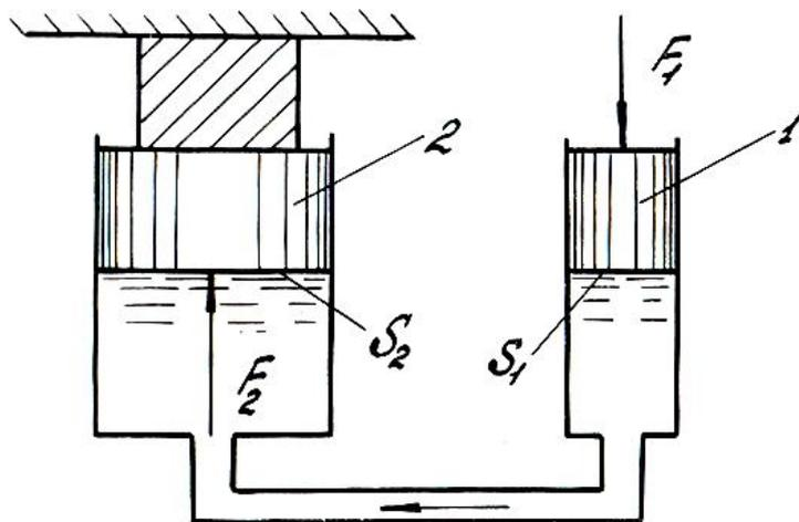
Рис. 2.7. Принципиальная схема гидравлического пресса
