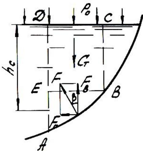
Рис. 2.10. Схема определения силы давления жидкости на стенку
