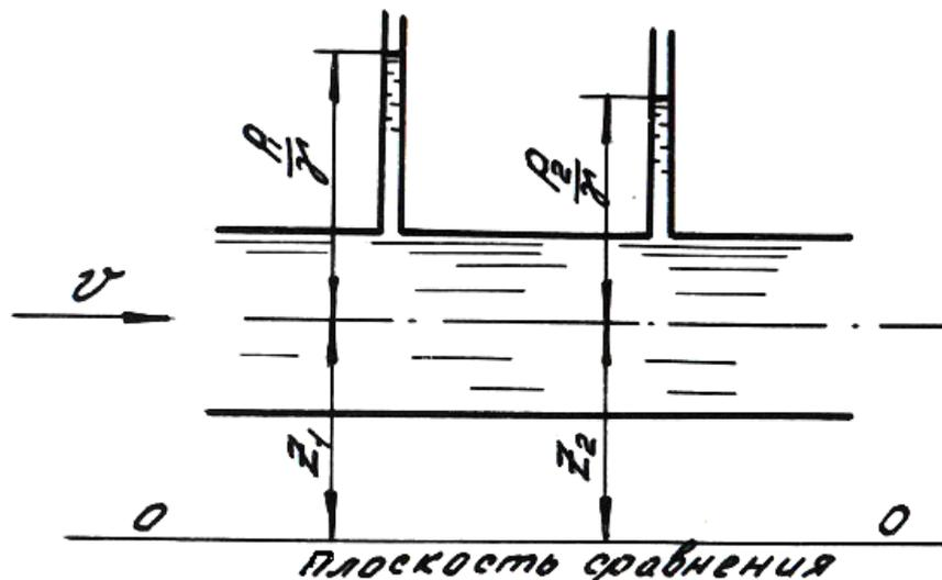
Рис. 3.10. Схема определения потерь напора по длине
