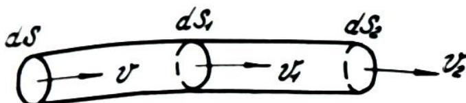
Рис. 3.6. Схема к выводу уравнения неразрывности потока жидкости
