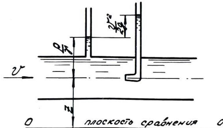
Рис. 3.8. Схема пьезометра и трубки Пито
