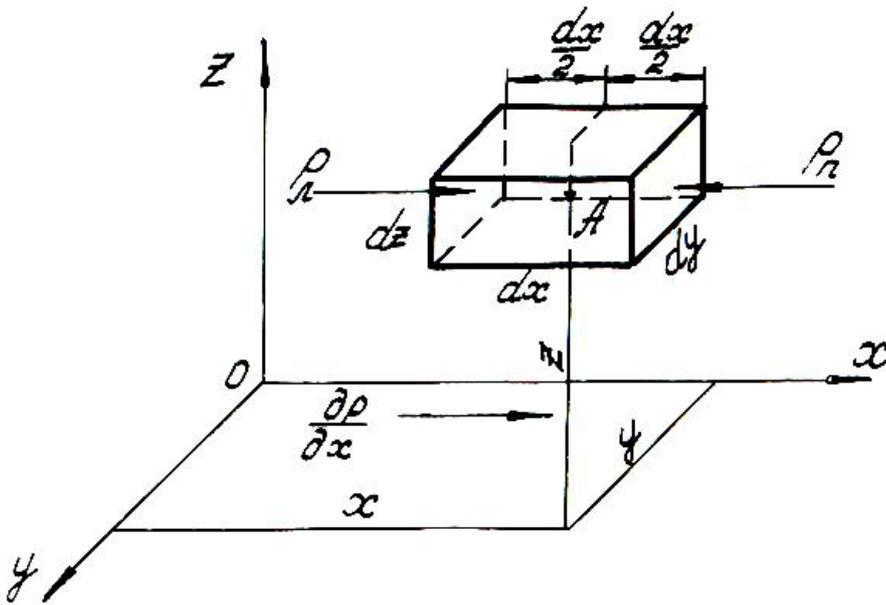
Рис. 2.3. Схема к выводу дифференциального уравнения равновесия жидкости
