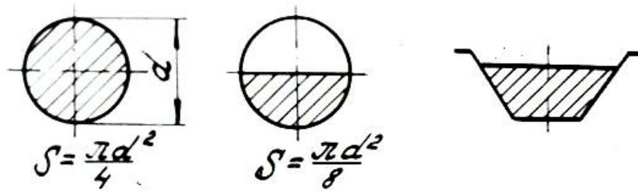
Рис. 3.3. Схема определения живого сечения потока
