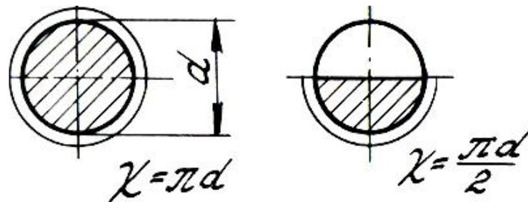
Рис. 3.4. Схема определения смоченного периметра
