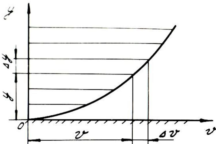
Рис. 1.1. Течение вязкой жидкости вдоль твердой стенки
