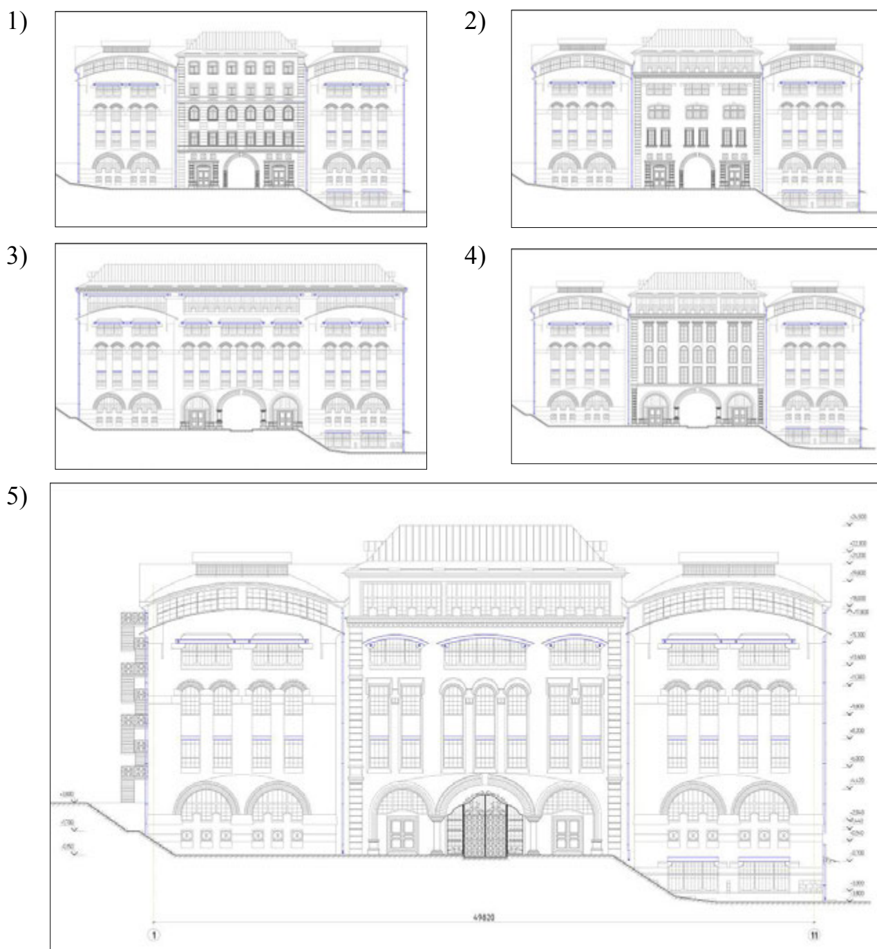
Рисунок 10 – Гостинично-ресторанный комплекс «Ермолаев» - реконструкция здания бывшего пивоваренного завода купцов Ермолаевых в Нижнем Новгороде: 1...4 - эскизные варианты представления главного фасада; 5-главный фасад (основной вариант)
