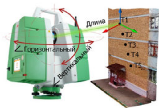
Рисунок 1 – Принципиальная схема метода наземного лазерного сканирования
