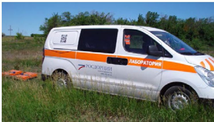
Рисунок 1 – Дорожная лаборатория ФАУ «РОСДОРНИИ» с георадаром «ОКО-2» с антенным блоком АБ-150 при выполнении работ у оснований откосов высоких насыпей
