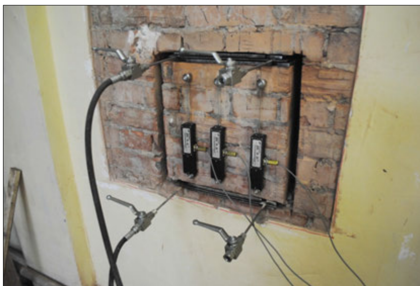
Рисунок 5 – Испытание кладки с вертикальными штрабами
