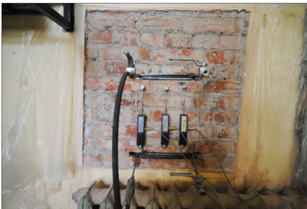
Рисунок 3 – Испытание кладки по методике ASTM 1197
