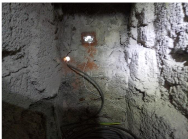
Рисунок 8 - Датчик температуры (ПДТ 2) внутренней поверхности кирпичной облицовки
