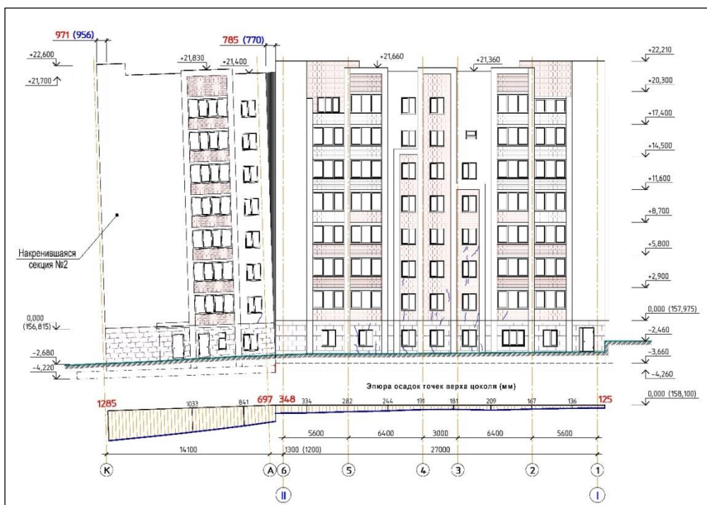
Рисунок 11 - Картограмма расположения трещин в наружных стенах секций №2 и №1, ориентированных вдоль оси «К», на участке в осях II-I
