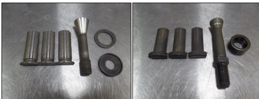
Рисунок 5 – Анкеры приборов ПОС (слева) и ОНИКС (справа)
