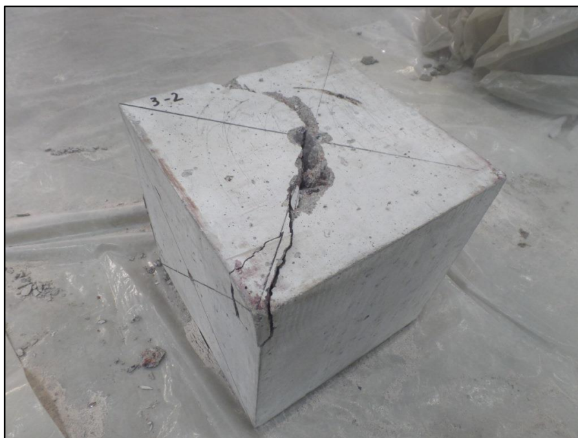
Рисунок 2 – Значительное разрушение образцов-кубов после отрыва
