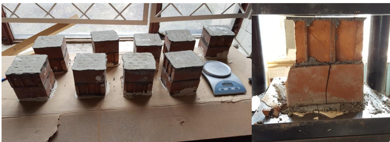
Рисунок 17 – Испытания образцов под действием циклической нагрузки
