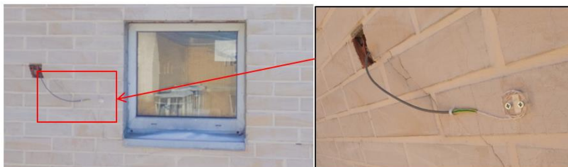
Рисунок 7 - Датчик температуры (ПДТ 3) наружной поверхности кирпичной облицовки
