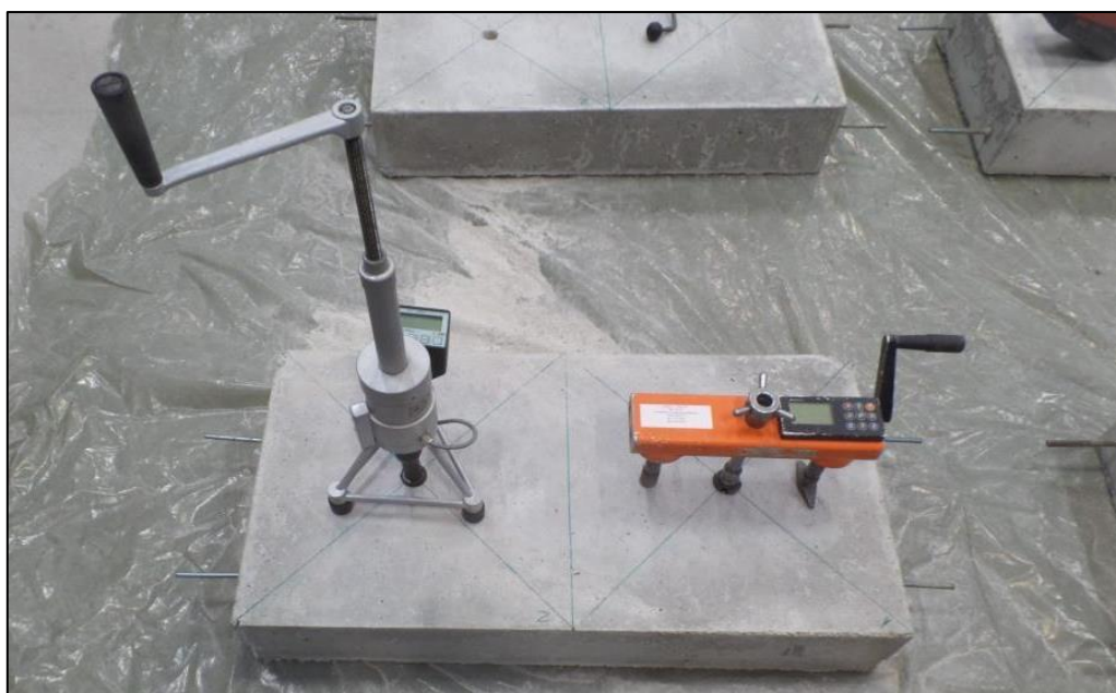
Рисунок 4 – Проведение параллельных испытаний приборами ПОС (слева) и ОНИКС (справа)
