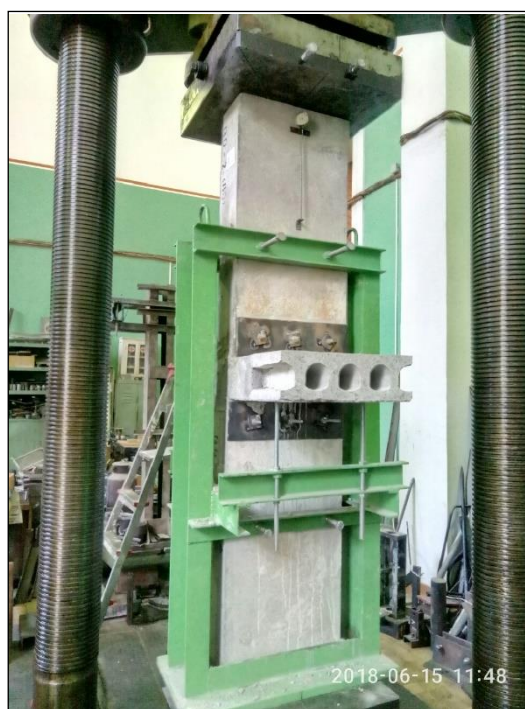
Рисунок 9 - Испытание образцов усиленных платформенных стыков
