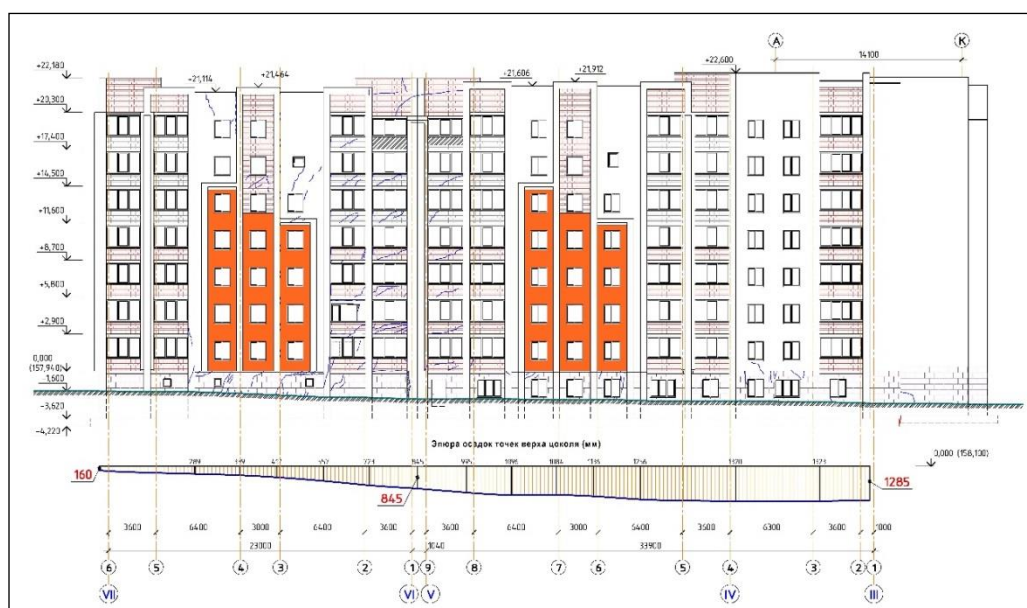
Рисунок 12 - Картограмма расположения трещин в наружных стенах секций №3 и №2, ориентированных по оси «К», на участке в осях VII-III
