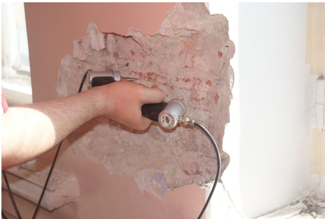
Рисунок 6 – Инструментальное измерение кирпичной кладки на прочность
