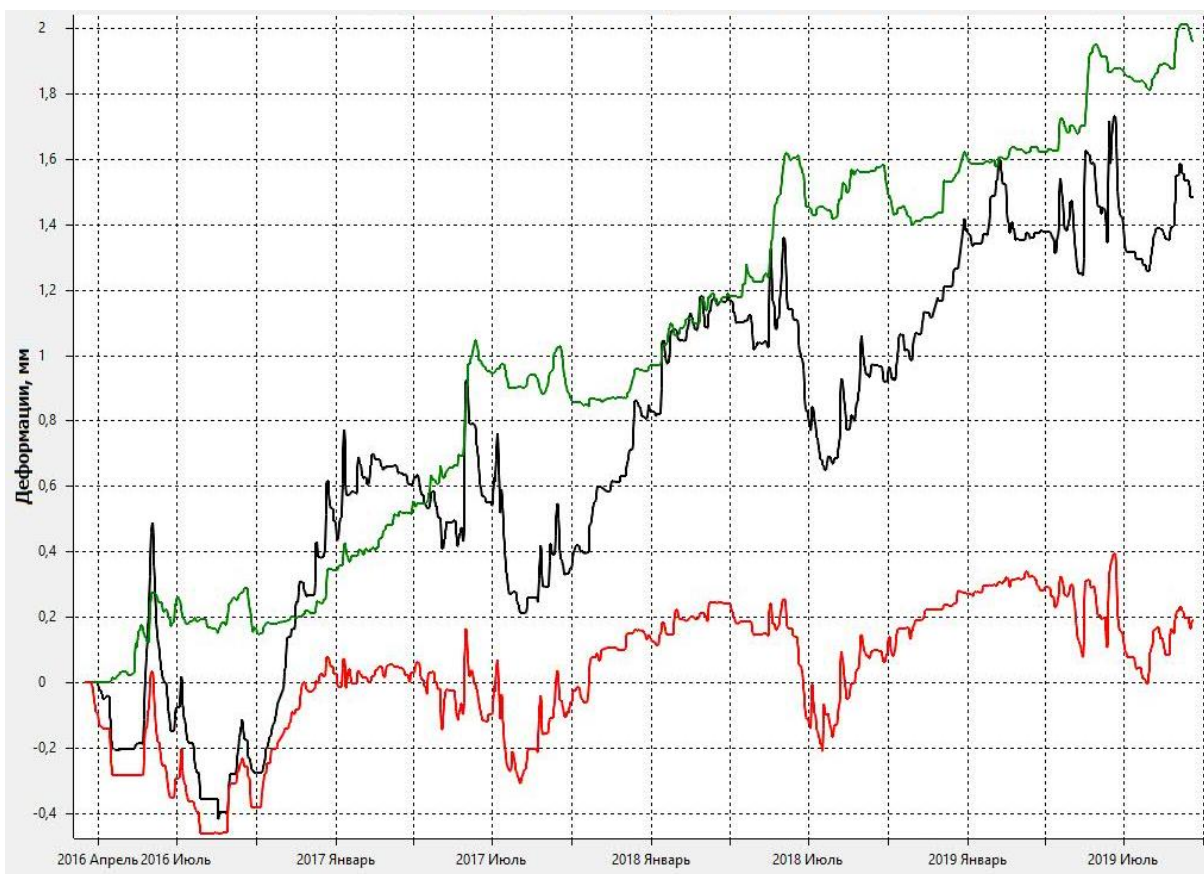
Рисунок 3 - График деформирования здания №1 за три года наблюдения
