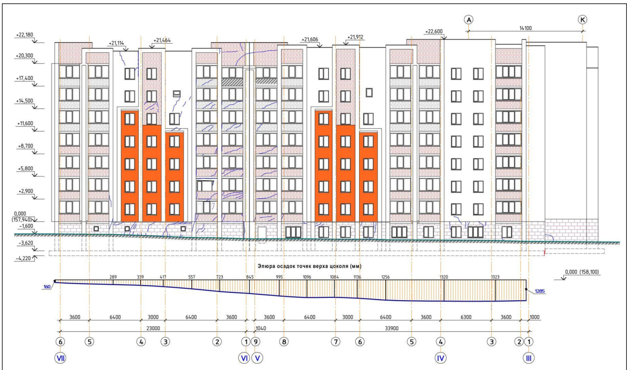
Рисунок 10 - Картограмма расположения трещин в наружных стенах секций №3 и №2 (вид со стороны оврага)
