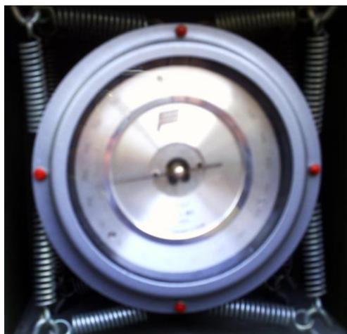
Рис. 14. Барометр–анероид
