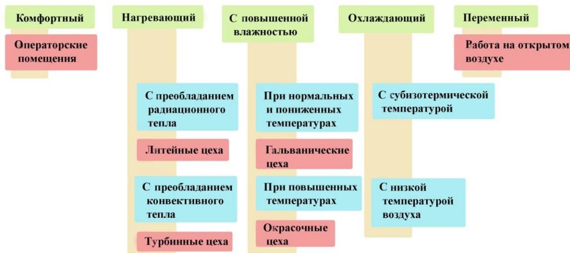
Рис. 3. Классификация производственных помещений по производственному микроклимату
