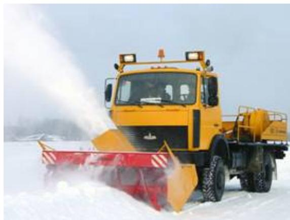
Рис. 5.2. Снегоочиститель фрезерно-роторный
