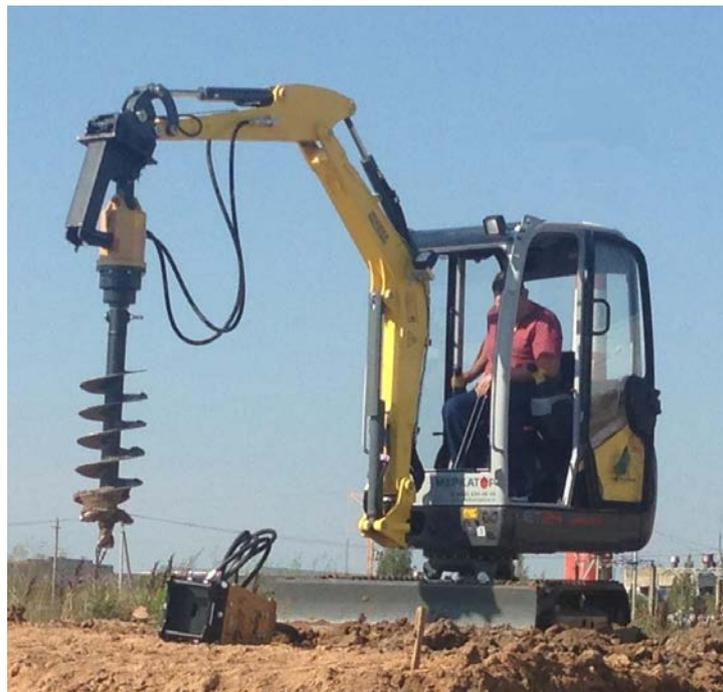
Рис. 2.4. Установка гидробура на манипуляторе
