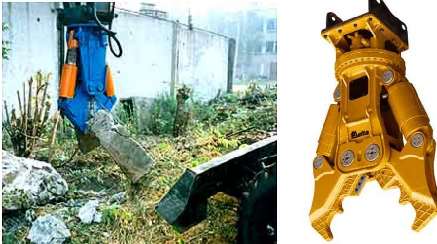
Рис. 1.10. Гидроножницы (бетоноломы)
