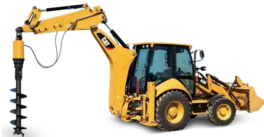
Рис. 2.1. Установка гидробура на экскаватор
