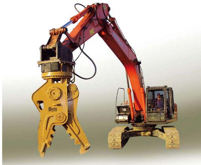
Рис. 1.11. Экскаватор с гидроножницами (бетоноломами)
