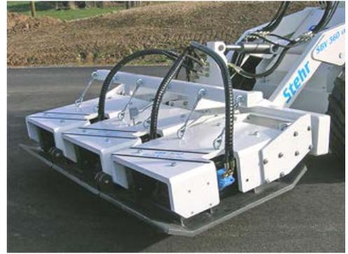
Рис. 4.4. Трамбовочные пластины SBV 360 4WD STEINR
