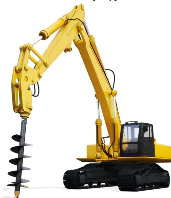
Рис. 2.2. Установка гидробура на экскаватор
