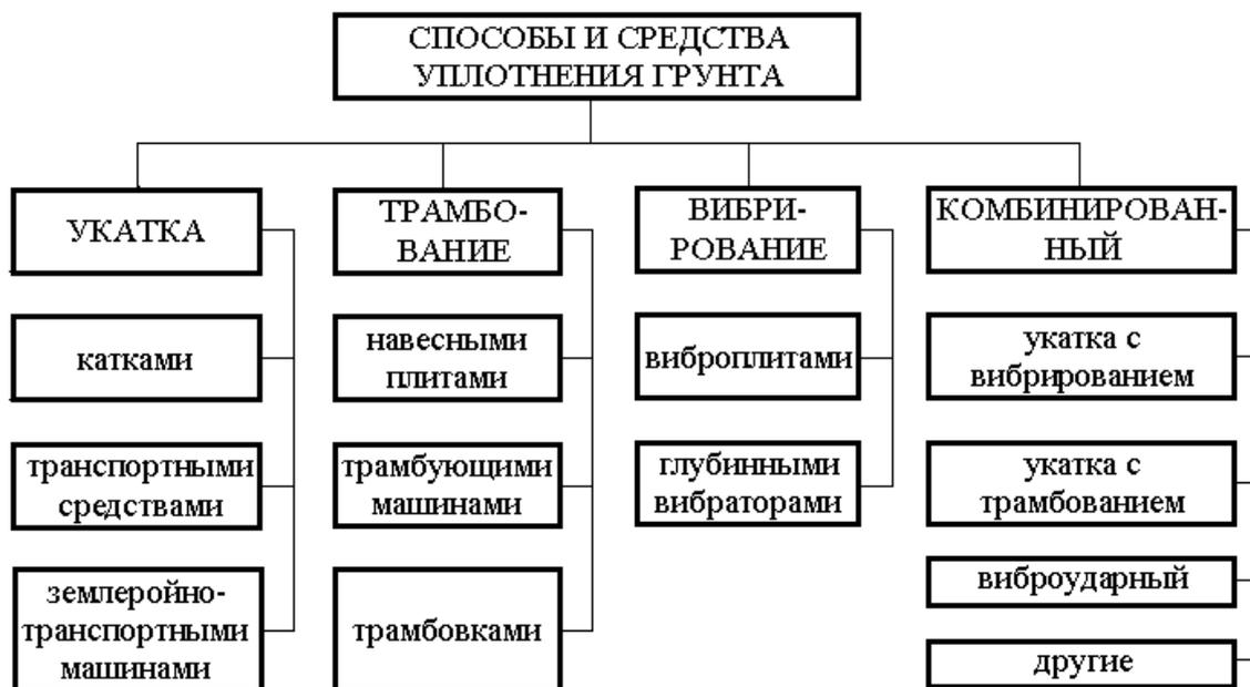
Рис. 4.1. Классификация способов и средств механизированного уплотнения грунтов
