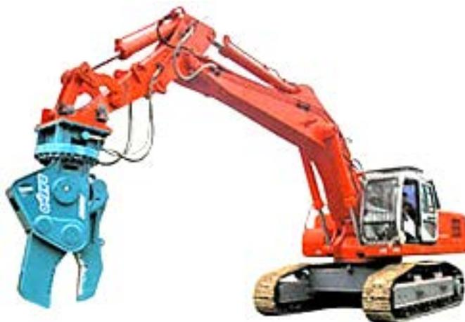
Рис. 1.2. Экскаватор с гидравлическими ножницами
