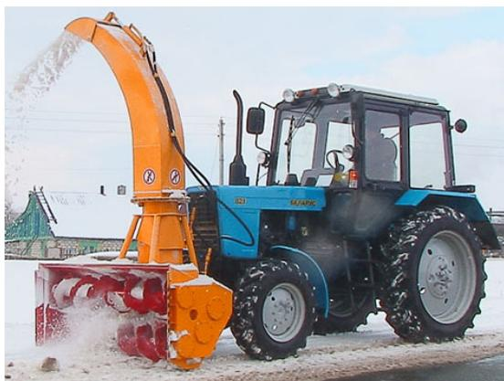
Рис. 5.1. Шнекороторный снегоочиститель ФРС-200 М
