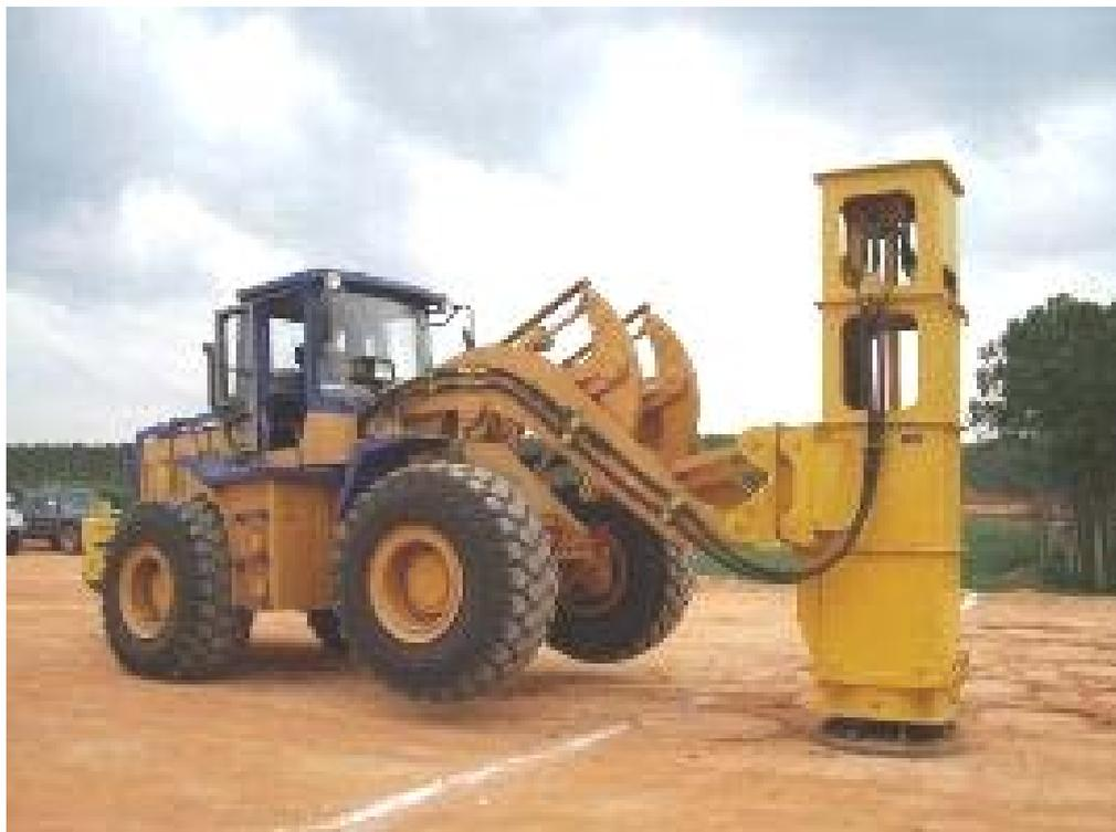
Рис. 4.3. Трамбующая машина
