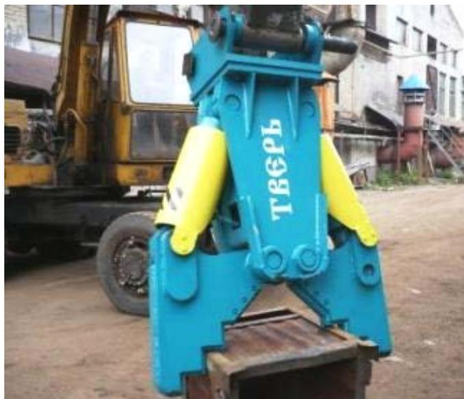
Рис. 1.18. Бетонолом НГБ-73 ОАО («Тверской машзавод Гидромолот»)
