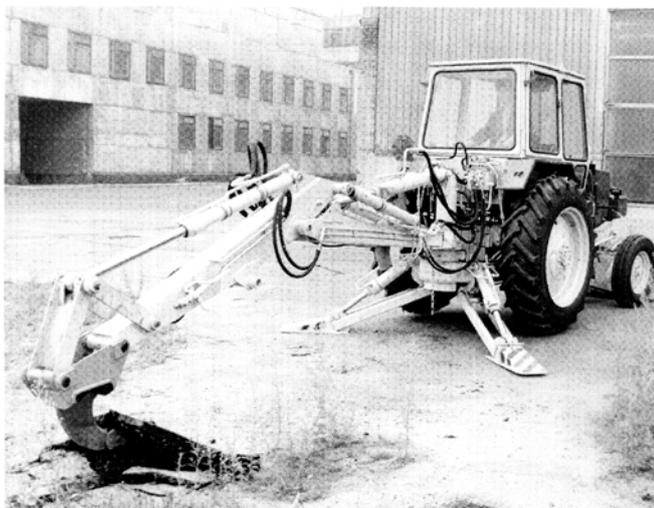
Рис. 3.1. Зуб-рыхлитель к экскаватору ЭО-2621 В2
