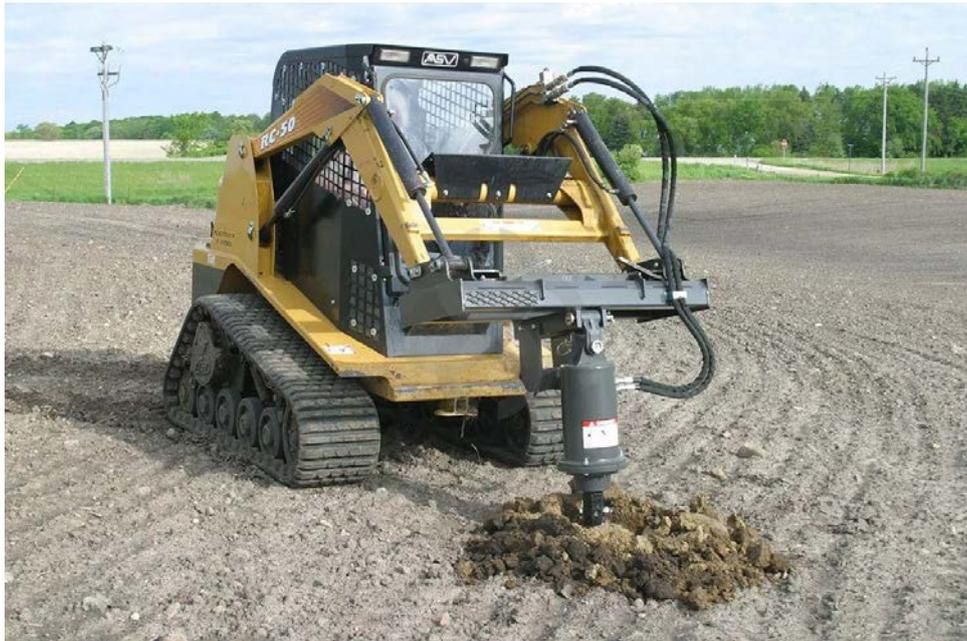
Рис. 2.3. Установка гидробура на мини-погрузчике
