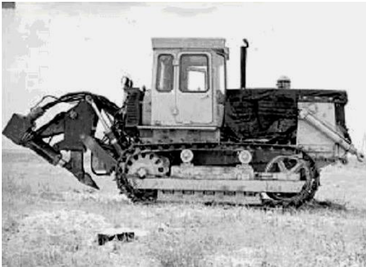
Рис. 9.3. Рыхлитель активного действия на базе трактора
