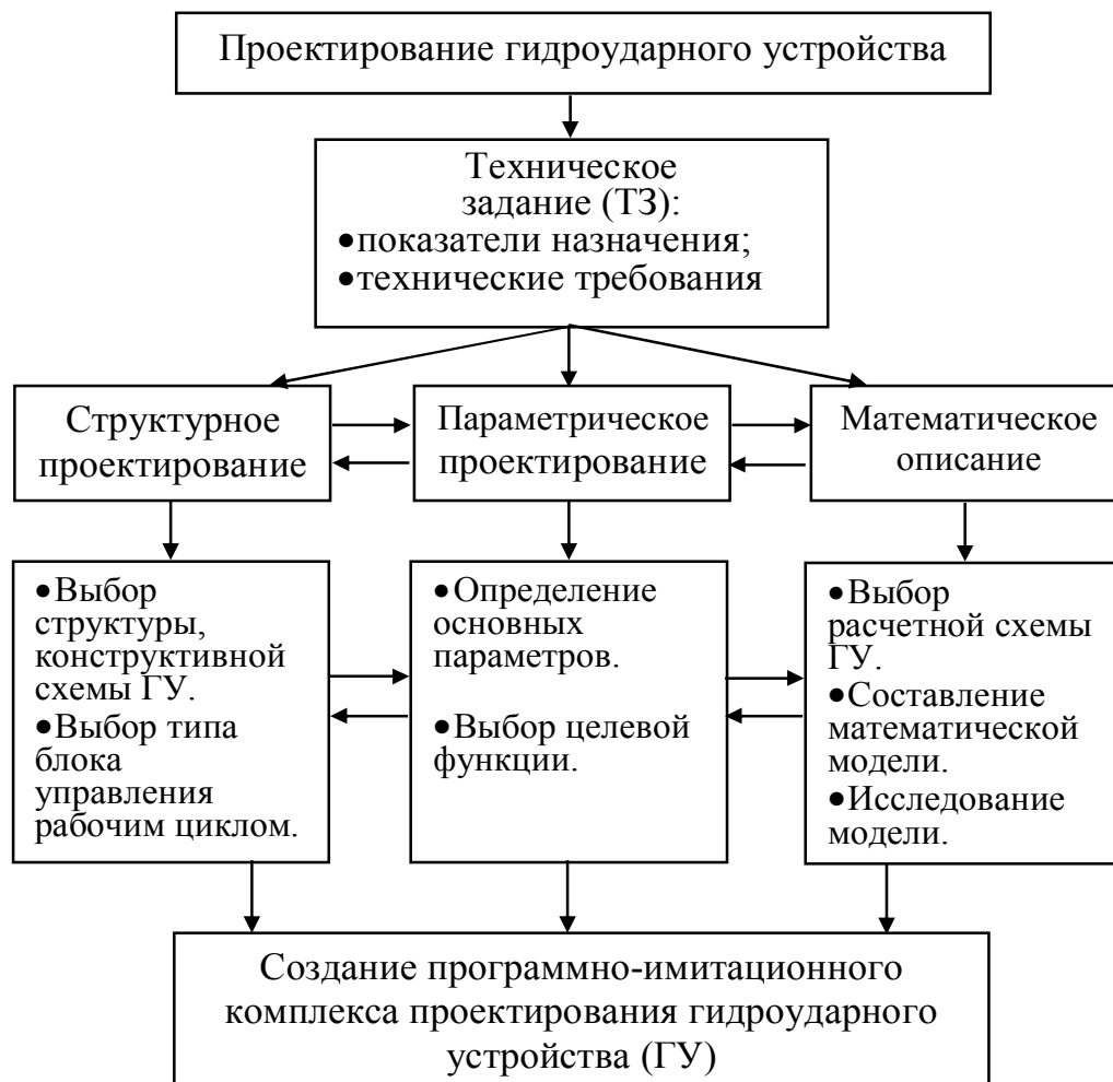
Рис.1.8. Алгоритм проектирования гидроударной импульсной системы
