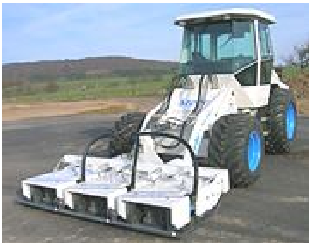
Рис. 2.10. Трамбовочные пластины SBV 360 4WD STEHR
