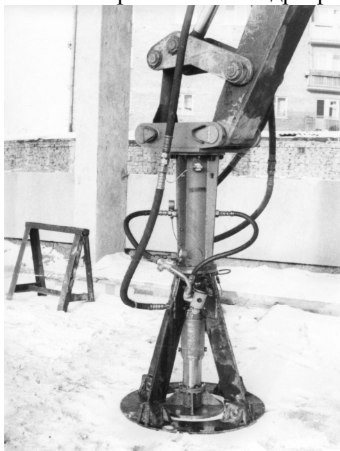
Рис. 1.2. Гидротрамбовка к экскаватору
