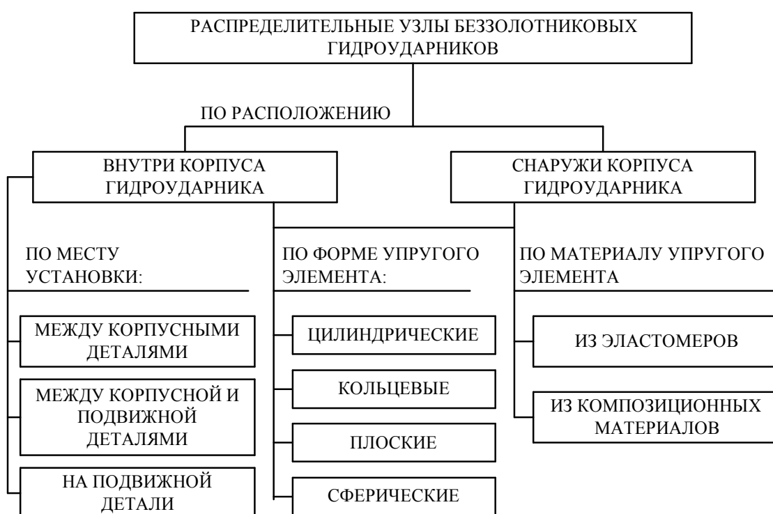
Рис. 1.6. Классификация распределительных узлов беззолотниковых гидроударников
