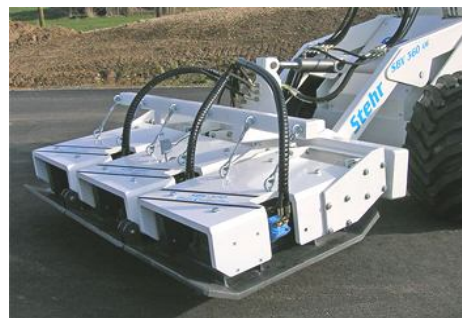
Рис. 2.10. Трамбовочные пластины SBV 360 4WD STEHR
