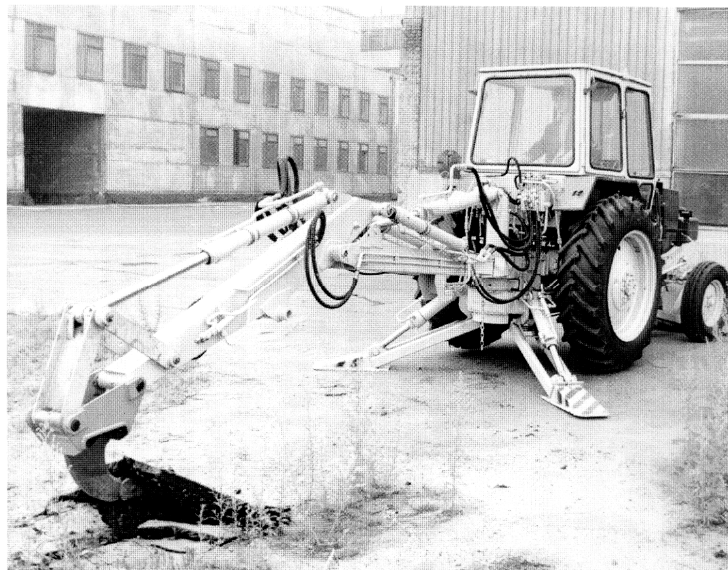
Рис. 1.3. Зуб-рыхлитель к экскаватору ЭО-2621 В2
