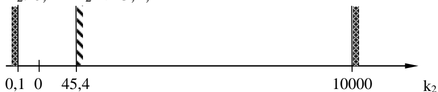
Рисунок 3 – Границы предельных значений коэффициента k_2 и устойчивости системы
