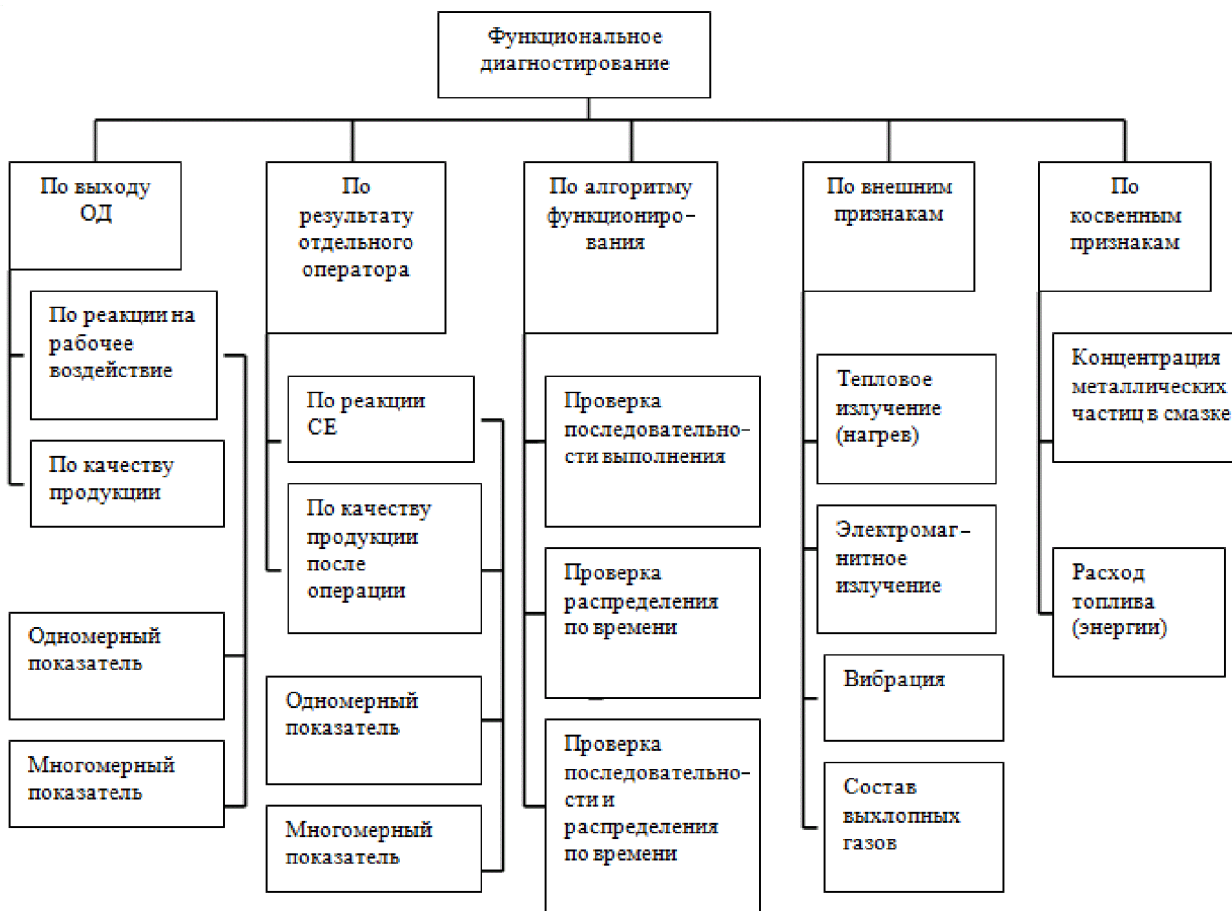
Рис. 5.3. Классификация методов функционального диагностирования
