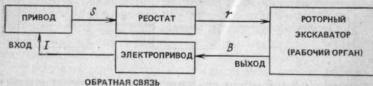
7. Принцип действия полуавтоматической системы регулирования скорости движения роторного экскаватора
