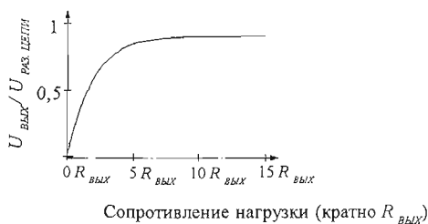
Рис. 2.23. Зависимость выходного напряжения схемы от сопротивления нагрузки
