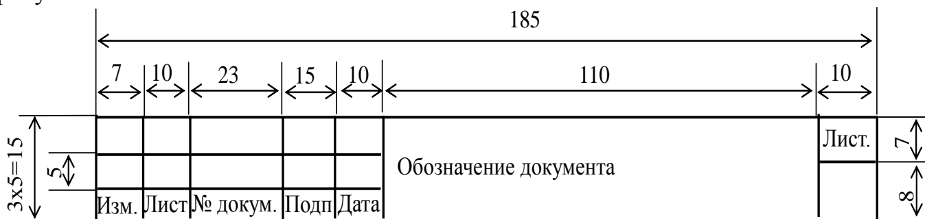
Рисунок 5.3 – Угловой штамп для чертежей (схем) (последующие листы)
