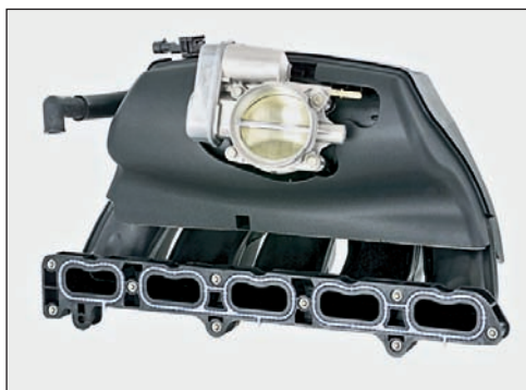
Рис. 2.70. Пластмассовый впускной трубопровод с ресивером и дроссельным патрубком
