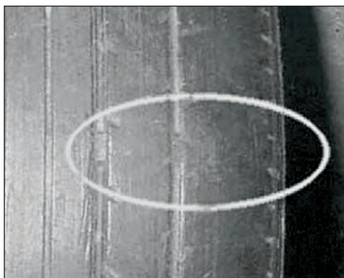
Рис. 4.12. Индикатор износа шины. Выступы в канавках протектора шины имеют высоту 1,6 мм и свидетельствуют о полном износе шины
