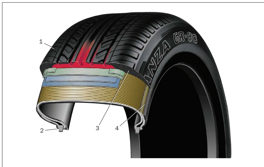
Рис. 4.6. Конструкция пневматической шины: 1 — двухслойный протектор (красным выделена мягкая резина); 2 — специальная форма бортового кольца; 3 — плечевые части, устойчивые к порезам; 4 — защитный бортовой слой
