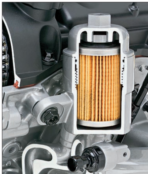
Рис. 2.42. Масляный фильтр со сменным фильтрующим элементом
