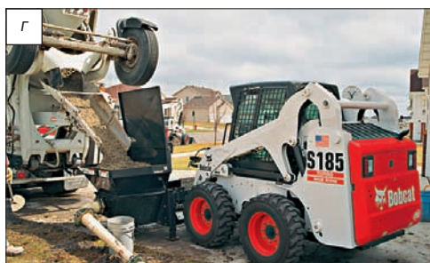
Рис. 5.1. Способы поворота колесной машины: а — за счет поворота оси; б — за счет поворота управляемых колес; в — складыванием рамы; г — силовым способом
