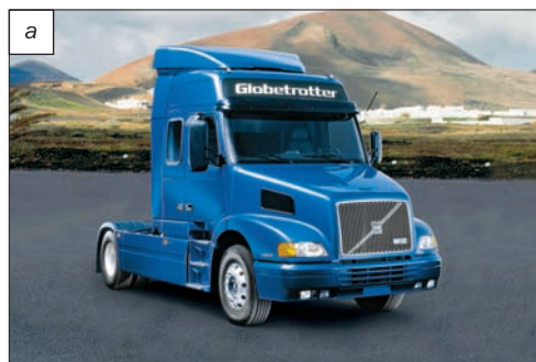
Рис. 7.9. Типы кабин: а — капотный; б — бескапотный
