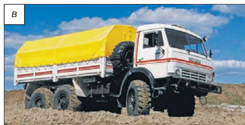
Рис. 1.30. Грузовые автомобили: а, б — двухосный; в — трехосный; г — четырехосный; д — пятиосный
