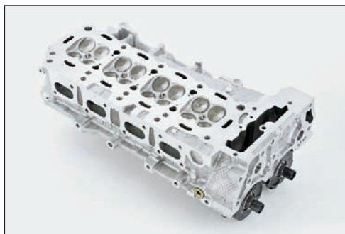
Рис. 2.20. Головка блока четырехцилиндрового рядного двигателя с двумя распределительными валами и четырьмя клапанами на цилиндр
