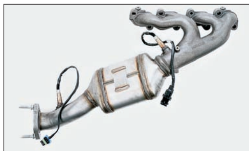
Рис. 2.78. Выпускной коллектор двигателя с предварительным нейтрализатором
