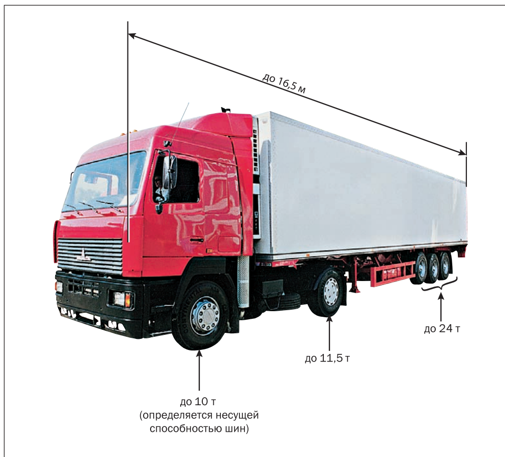
Рис. 1.10. Весовые и габаритные ограничения в РФ для пятиосного седельного автопоезда: габаритная ширина до 2,55 м (рефрижераторы до 2,60 м); полная масса до 40 т; высота до 4 м; длина до 16,5 м
