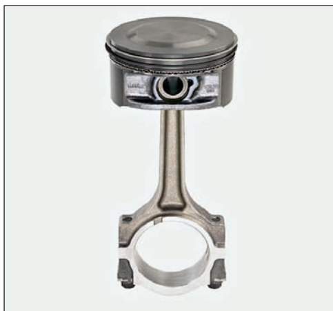
Рис. 2.22. Рабочая поверхность юбки поршня двигателя Ford Duratec покрыта антифрикционным слоем. Разъем нижней головки шатуна выполнен по специальной технологии, с помощью местного разрыва, что обеспечивает исключительно точное совпадение сопрягаемых деталей
