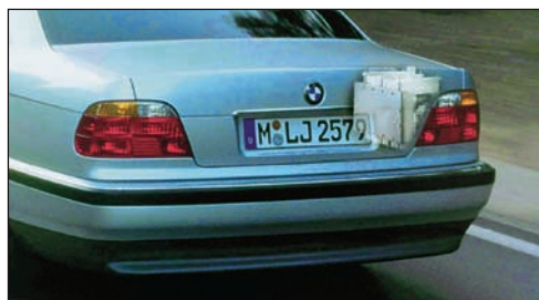
Рис. 8.18. BMW 750 hL — первый в мире серийный автомобиль с топливным элементом вместо аккумуляторной батареи
