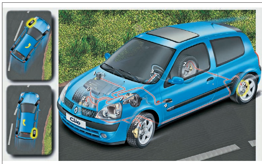
Рис. 5.15. Электронная система стабилизации траектории: 1 — блок управления АБС; 2 — датчик скорости вращения колес; 3 — датчик угла поворота руля; 4 — датчик бокового ускорения и угловой скорости; 5 — электронный блок управления (ЭБУ); 6 — электропривод дроссельной заслонки (бензиновый двигатель) или ТНВД (дизель); 7 — датчик давления в тормозной системе
