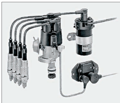
Рис. 2.118. Бесконтактная система зажигания Bosch
