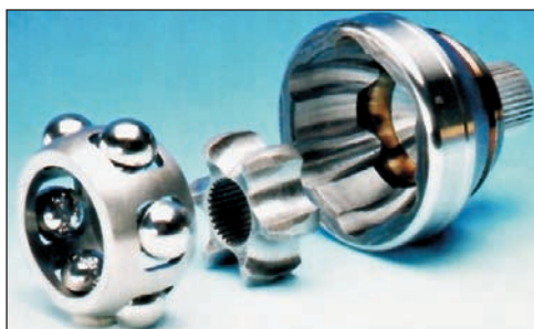
Рис. 3.24. Шестишариковый шарнир с делительными канавками
