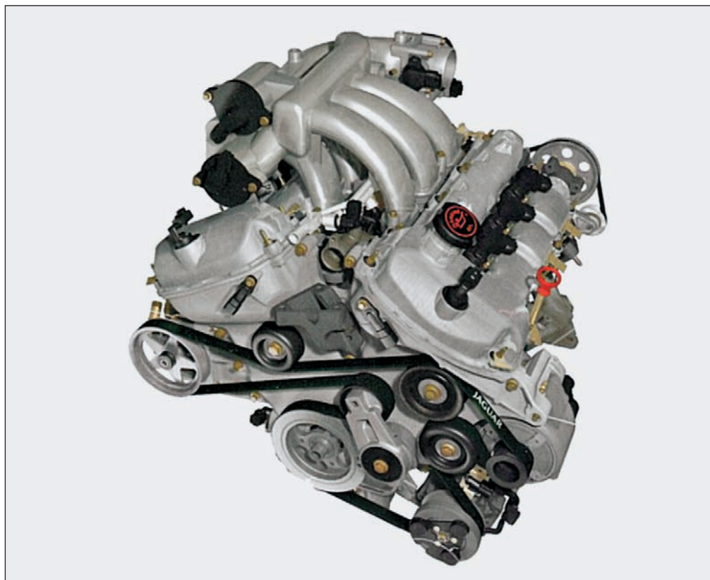
Рис. 2.18. Двигатель Jaguar с алюминиевым блоком. Блок цилиндров этого компактного шестицилиндрового V-образного 24-клапанного двигателя, предназначенного для поперечной установки на автомобиль Jaguar X-type, полностью изготовлен из алюминиевого сплава
