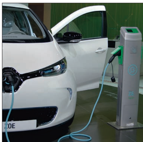
Рис. 8.3. Зарядная станция для электромобиля
