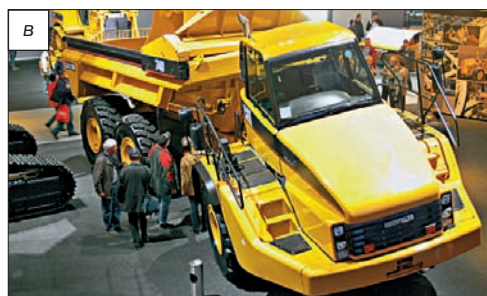
Рис. 5.1. Способы поворота колесной машины: а — за счет поворота оси; б — за счет поворота управляемых колес; в — складыванием рамы; г — силовым способом
