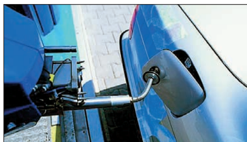
Рис. 8.20. Заправка водородом автомобиля BMW производится роботом, водитель не участвует в этом процессе
