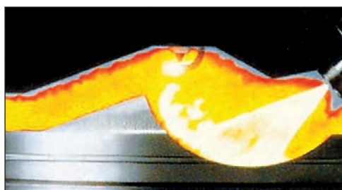
Рис. 2.83. Поршень двигателя с непосредственным впрыском бензина имеет специальную форму (процесс сгорания над поршнем)
