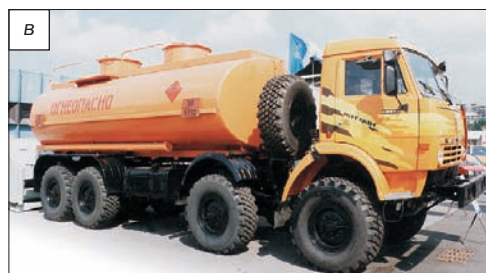
Рис. 7.11. Специализированные кузова грузовых автомобилей: а — карьерный самосвал; б — фургон на шасси МАЗ; в — цистерна на шасси КамАЗ
