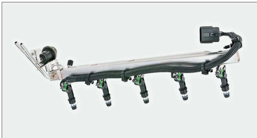
Рис. 2.67. Топливная рампа пятицилиндрового двигателя с установленными на ней форсунками, регулятором давления и штуцером для контроля давления
