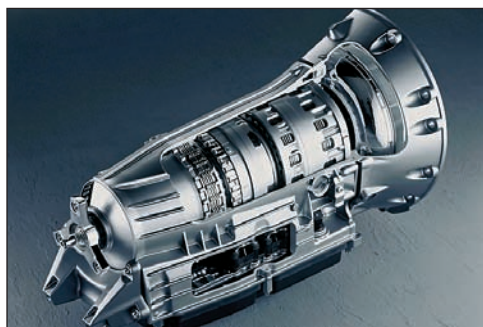
Рис. 3.40. Гидромеханическая коробка передач 7G-Tronic — первая в мире семиступенчатая автоматическая коробка (Mercedes-Benz)
