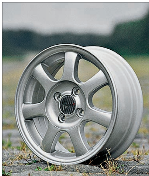
Рис. 4.2. Неразборное колесо с глубоким ободом
