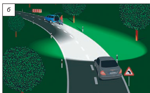
Рис. 7.35. Освещение дороги фарами ближнего света: а — обычными фарами с асимметричным лучом; б — активной системой освещения
