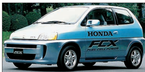
Рис. 8.13. Автомобиль Honda FCX использует для движения электрическую энергию, получаемую с помощью топливных элементов
