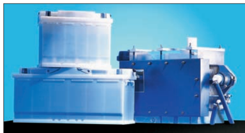
Рис. 8.19. Топливный элемент автомобиля BMW 750 hL не превосходит размерами обычный свинцово-кислотный аккумулятор
