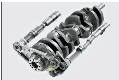
Рис. 2.12. Балансирные валы двигателя GM Vortec 2004 г. располагаются рядом с коленчатым валом в блоке цилиндров и имеют возможность вращаться в разные стороны благодаря шестеренчатому приводу. Для снижения шума используются гидравлический натяжитель и успокоители цепи
