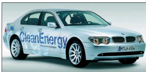
Рис. 8.1. Автомобиль BMW 740 hL имеет бак с жидким водородом, который используется, как топливо для ДВС и для топливного элемента, заменяющего обычный аккумулятор. Использование топливного элемента обеспечивает работу кондиционера на стоянках с неработающим двигателем
