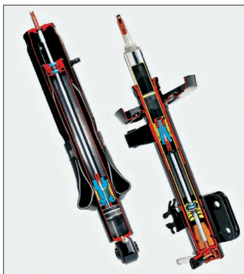
Рис. 4.36. Амортизаторы Magneride фирмы Delphi изменяют гасящие свойства при намагничивании специальной жидкости
