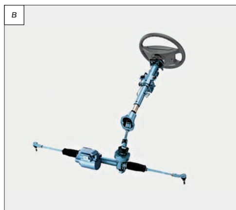
Рис. 5.14. Электрические усилители рулевого управления: а — с воздействием на рулевой вал; б — с воздействием на шестерню рулевого механизма; в — с воздействием на рейку рулевого механизма
