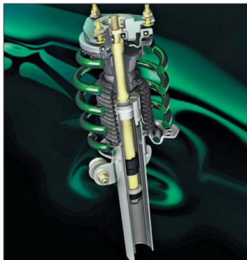
Рис. 4.25. Пружина подвески автомобиля Jaguar с переменной жесткостью
