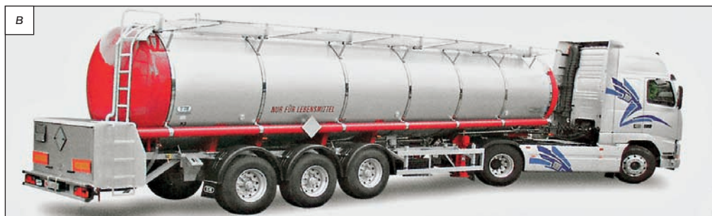
Рис. 1.31. Грузовые автомобили с различными кузовами: а — самосвал; б — фургон; в — в составе седельного тягача и автоцистерны-полуприцепа
