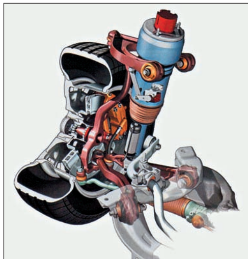
Рис. 4.30. Пневмоподвеска. На новых автомобилях Mercedes E-класса вместо пружин стали применяться пневматические упругие элементы
