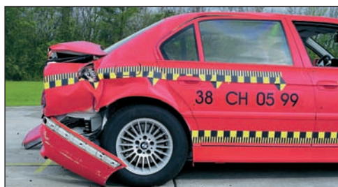
Рис. 8.17. Испытания на безопасность автомобиля BMW 750 hL по существующим методикам подтвердили безопасность использования топливного бака с жидким водородом
