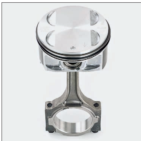
Рис. 2.21. Поршни современных двигателей имеют тенденцию к уменьшению высоты юбки
