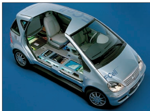
Рис. 8.12. Автомобиль на топливных элементах производства DaimlerChrysler изготовлен на базе Mercedes А-класса, использует силовую установку, расположенную под полом автомобиля
