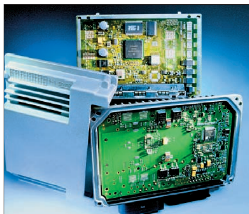
Рис. 2.63. Электронный блок управления четырехцилиндровым двигателем Valvetronic BMW
