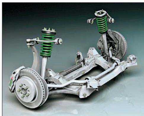
Рис. 4.41. Передняя подвеска автомобиля Jaguar S-type имеет двойные поперечные рычаги и очень длинную поворотную цапфу. Такая конструкция обеспечивает большое пространство для размещения агрегатов под капотом автомобиля
