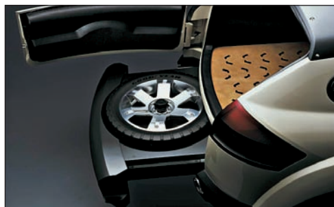
Рис. 4.16. На некоторых автомобилях запасное колесо располагается в выдвижном контейнере, под полом багажного отделения
