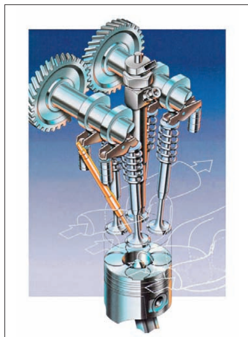
Рис. 2.30. Четырехклапанная камера сгорания. Применение газораспределительного механизма с четырьмя клапанами на цилиндр в дизельном двигателе
