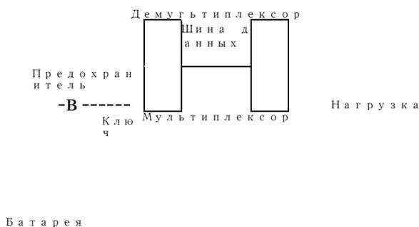
Рисунок 2.2 - Обычное и мультиплексное подключение нагрузок [19]
