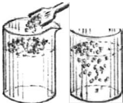
Рис. 11. Проба на гидрофобность: слева – цемент гидрофобный; справа – обычный
