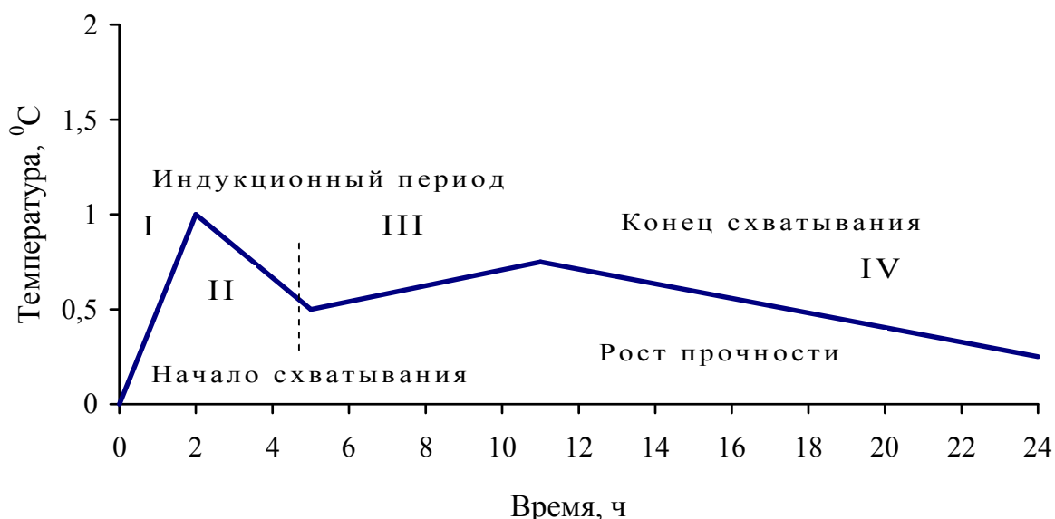
Рис. 5. Тепловыделения при взаимодействии цемента с водой
