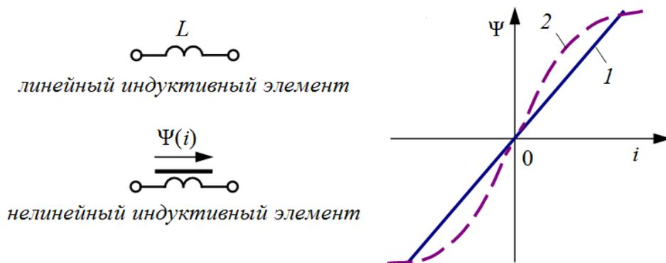
Основной характеристикой идеальной катушки индуктивности является зависимость  $\Psi(i)$ , называемая **вебер-амперной характеристикой**. Для линейных катушек индуктивности зависимость  $\Psi(i)$  представляет собой прямую линию, проходящую через начало координат, при этом  $L = \text{const}$ ;
