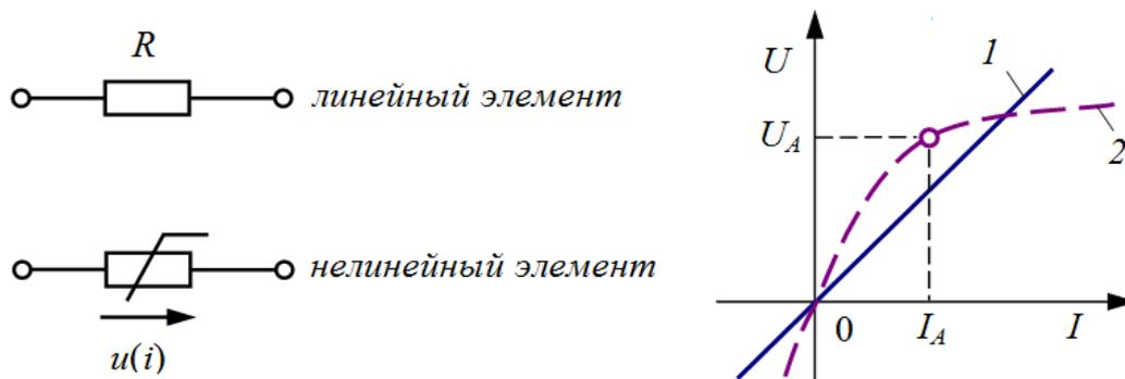
Основной характеристикой резистивного элемента является зависимость  $U(I)$  [или  $I(U)$ ], называемая **вольт-амперной характеристикой** (ВАХ). Если зависимость  $U(I)$  представляет собой прямую линию, проходящую через начало координат, то резистор называется линейным и описывается соотношением
