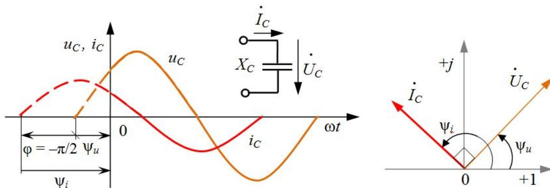
На графике мгновенных значений синусоидальных тока и напряжения ёмкостного элемента видно, что напряжение отстаёт от тока по фазе на угол  $\pi/2$ , т.е. сдвиг по фазе между напряжением и током
