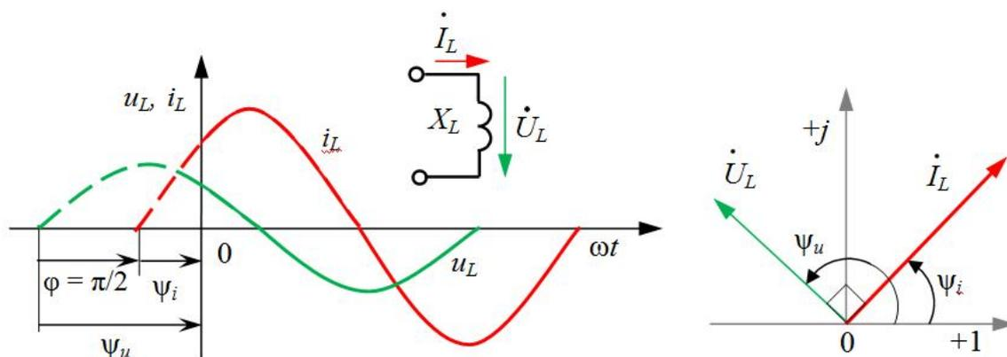
На графике мгновенных значений синусоидального тока и напряжения индуктивного элемента видно, что напряжение опережает ток по фазе на угол
