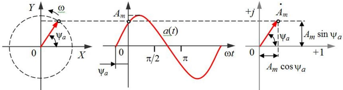
Если таким же образом на плоскости изобразить несколько векторов, соответствующих разным синусоидальным функциям, имеющим одинаковую частоту, то они будут вращаться совместно, не меняя взаимного положения, которое определяется только начальной фазой этих функций. Поэтому при анализе цепей, в которых все функции имеют одинаковую частоту, её можно исключить из параметров, ограничившись амплитудой и начальной фазой. В этом случае векторы, изображающие синусоидальные функции, будут неподвижными.
