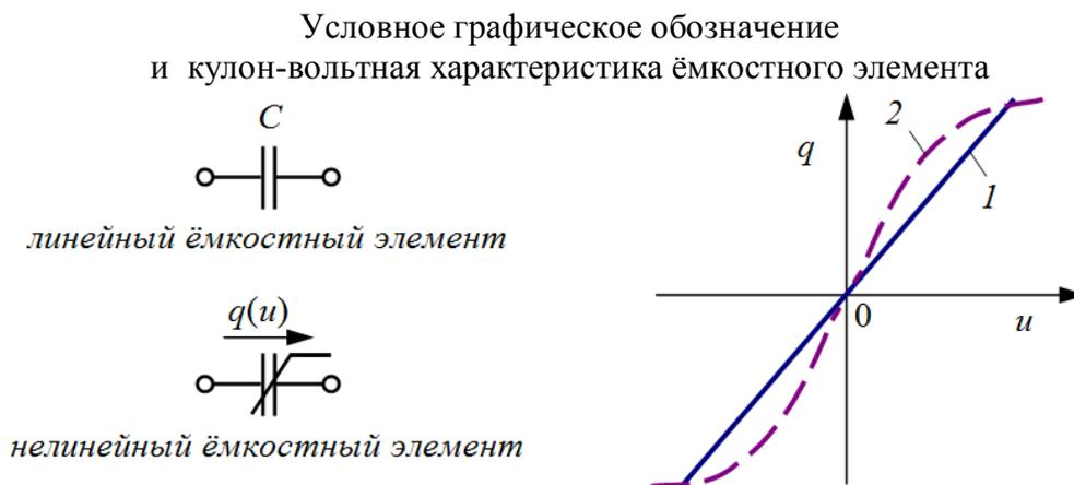
Основной характеристикой конденсатора является зависимость  $q(u)$ , называемая **кулон-вольтной характеристикой**. Большинство диэлектриков, используемых на практике, линейны, т.е. у них относительная диэлектрическая проницаемость  $\epsilon = \text{const}$ . В этом случае зависимость  $q(u)$  представляет собой прямую линию, проходящую через начало координат, при этом  $C = \text{const}$ ;
