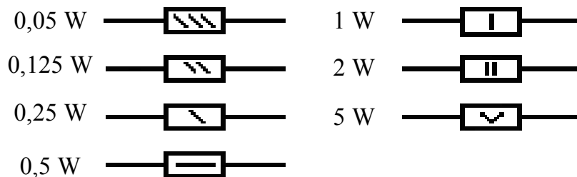
Рис. 6.7. Символы, обозначающие номинальную мощность резисторов
