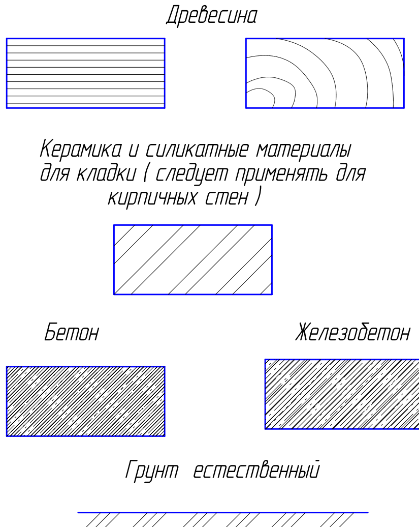
Рис. 97. Условные обозначения строительных материалов
