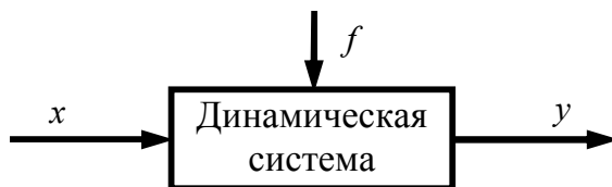
Рис. 2.1. Структурная схема модели вход-выход управляемой динамической системы
