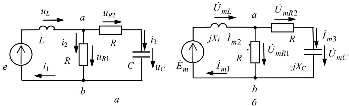
Рисунок 3 - Разветвлённая цепь синусоидального тока:
