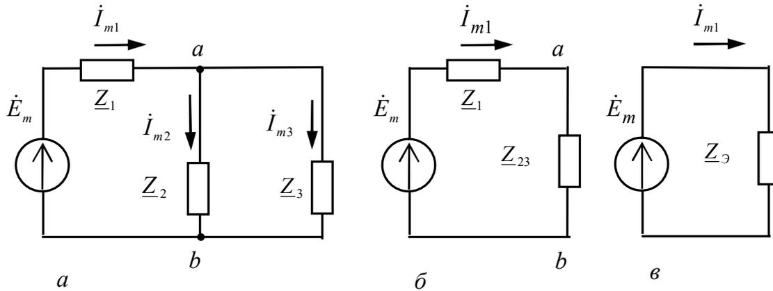
Рисунок 4 - Эквивалентные преобразования расчётной схемы
