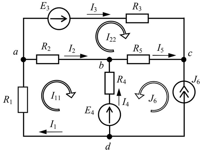
Рисунок 2 - Применение метода контурных токов
