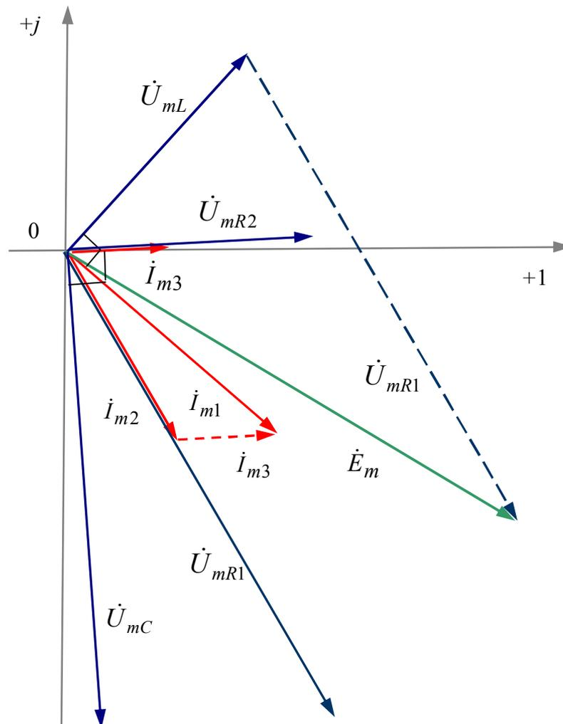
Рисунок 5 - Векторная диаграмма токов и напряжений
