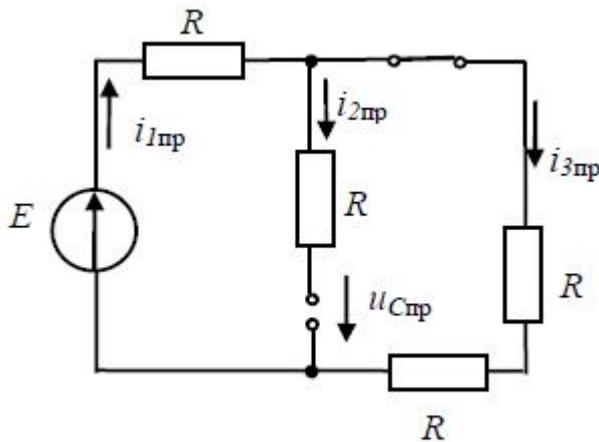
Ёмкостный элемент заменяем разрывом (для постоянного тока ( $X_C = \infty$ ), ключ замкнут).
