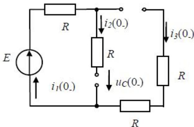
Ёмкостный элемент заменяем разрывом (для постоянного тока  $X_C = \infty$ ), ключ разомкнут.
