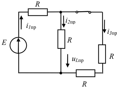
Индуктивный элемент заменяем перемычкой (для постоянного тока  $X_L=0$ ), ключ замкнут.
