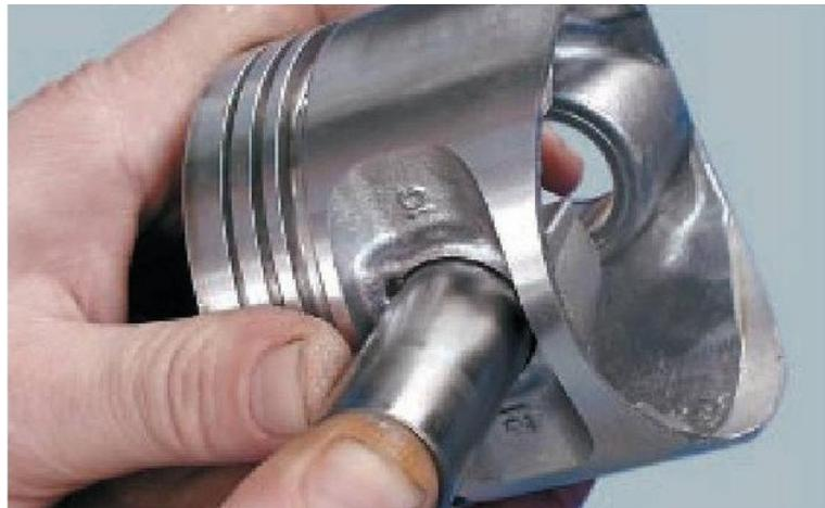
Рис. 10. Проверка посадки поршневого пальца в отверстия поршня
