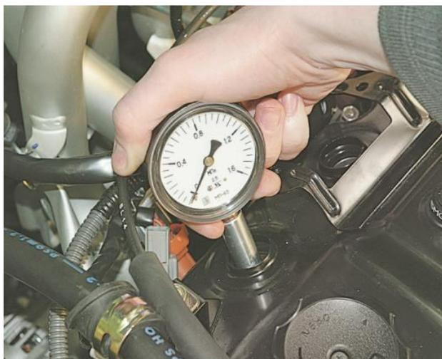
Рис. 3. Проверка компрессии в цилиндре двигателя
