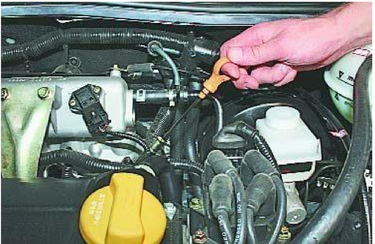
Рис. 4. Проверка уровня масла в картере двигателя
