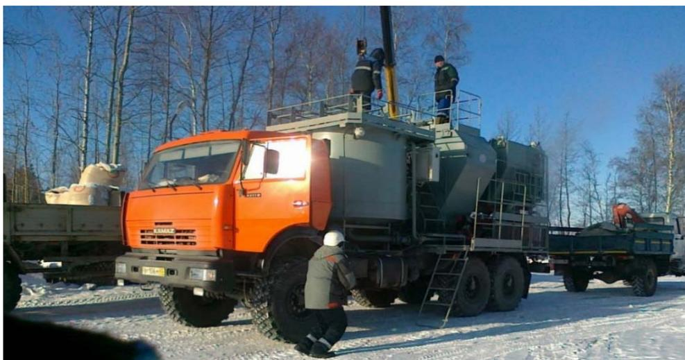
Рис. 2.114. Станция СКЦ «Раствор-М», смонтированная на установке УНС-500Д
