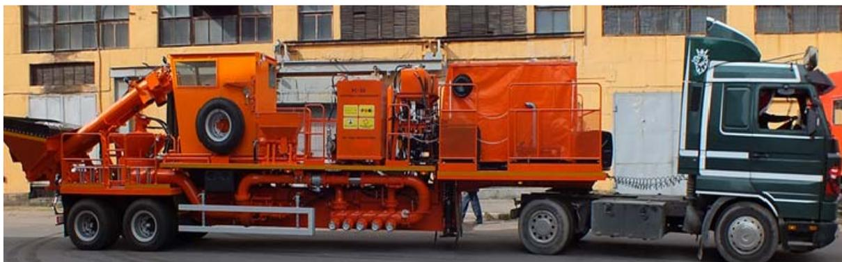
Рис. 2.34. Смесительная установка в транспортном положении
