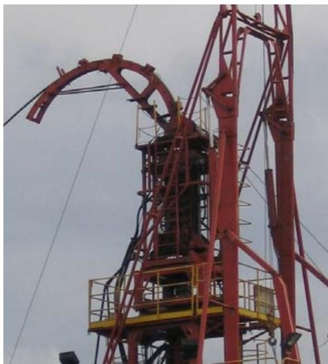
Рис. 2.74. Общий вид инжектора
