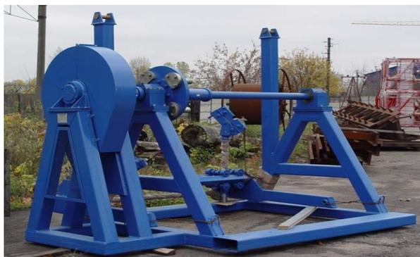
Рис. 2.75. Установка для перемотки трубы
