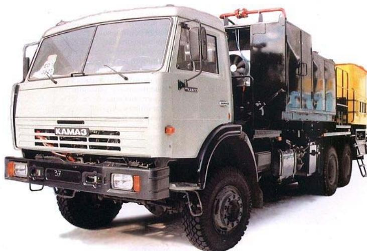
Рис. 1.8. Установка нагнетания газа УНГ 8/15
