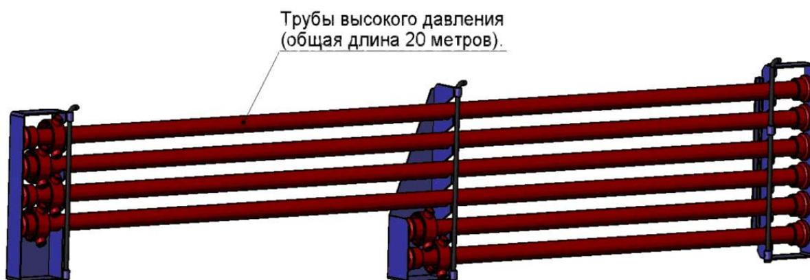
Рис. 2.9. Вспомогательный трубопровод
