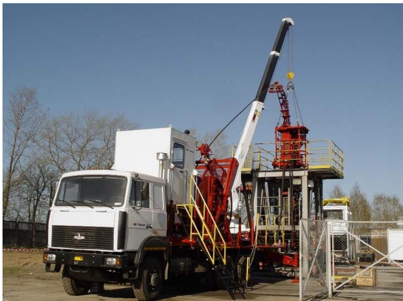
Рис. 2.63. Общий вид колтюбинговой установки МК10Т-10
