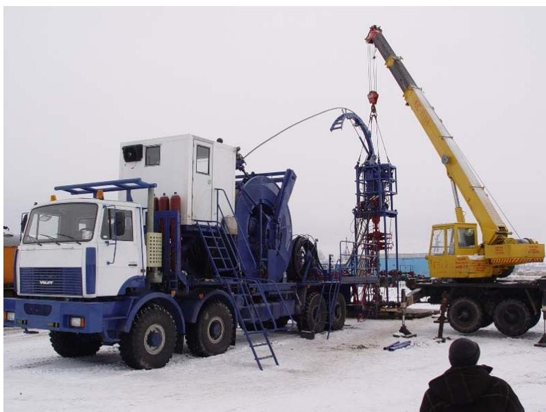
Рис. 2.65. Общий вид колтюбинговой установки МК20Т-10
