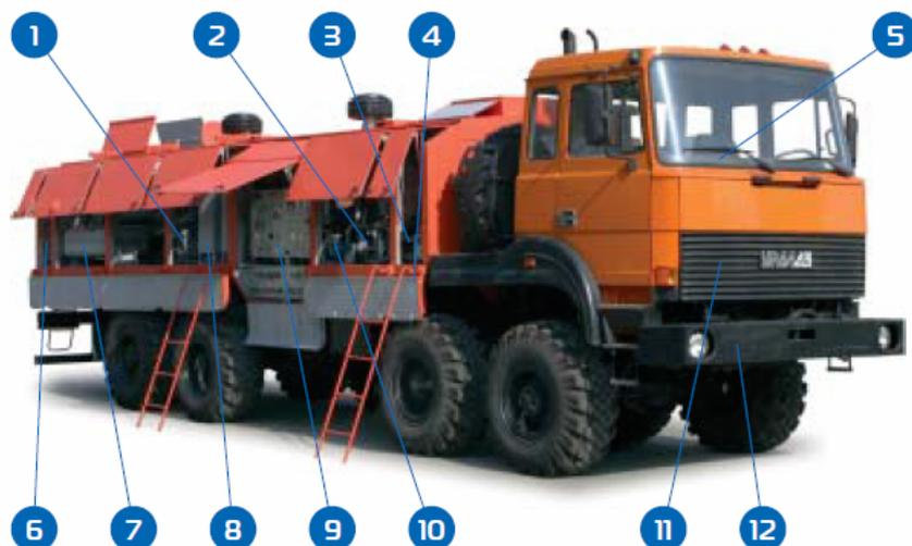
Рис. 2.104. Основное оборудование передвижной азотной компрессорной станции ПКСА 9/200: 1 – компрессор №1; 2 – компрессор №2; 3 – газоразделительный блок; 4 – дизельная электростанция; 5 – блок контроля внутри кабины; 6 – ПЖД №1; 7 – двигатель №1; 8 – автоматика; 9 – пульт управления; 10 – ПЖД №2; 11 – двигатель №2; 12 – шасси
