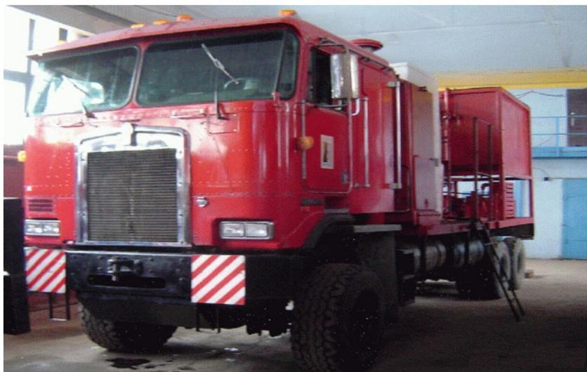
Рис. 2.105. Общий вид насосно-компрессорного агрегата Hydra Rig
