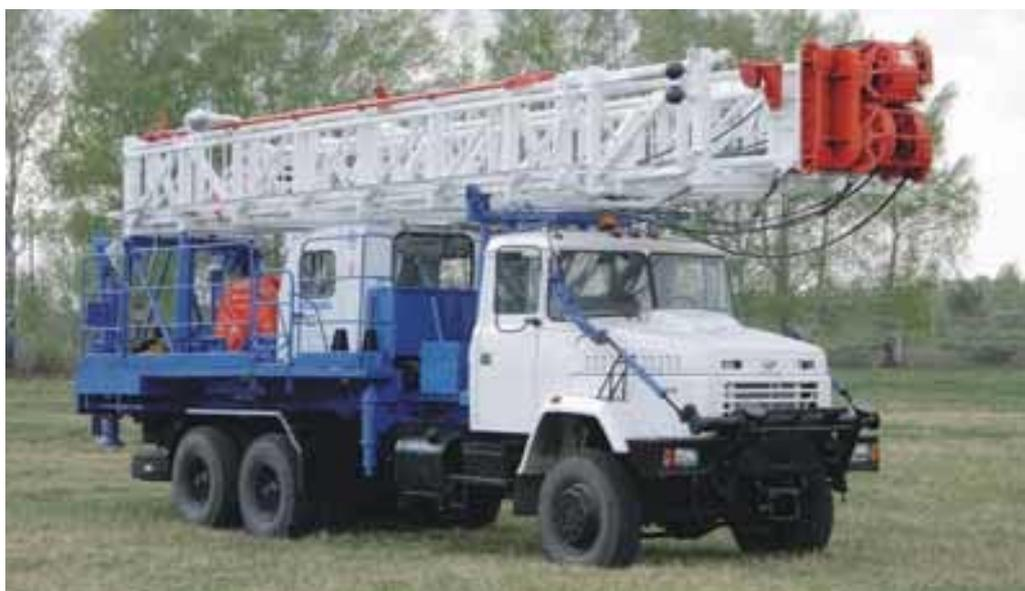
Рис. 2.45. Агрегат подъемный для ремонта скважин АПРС-50К
