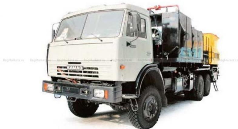
Рис. 2.86. Общий вид установки нагнетания газов УНГ 8/15
