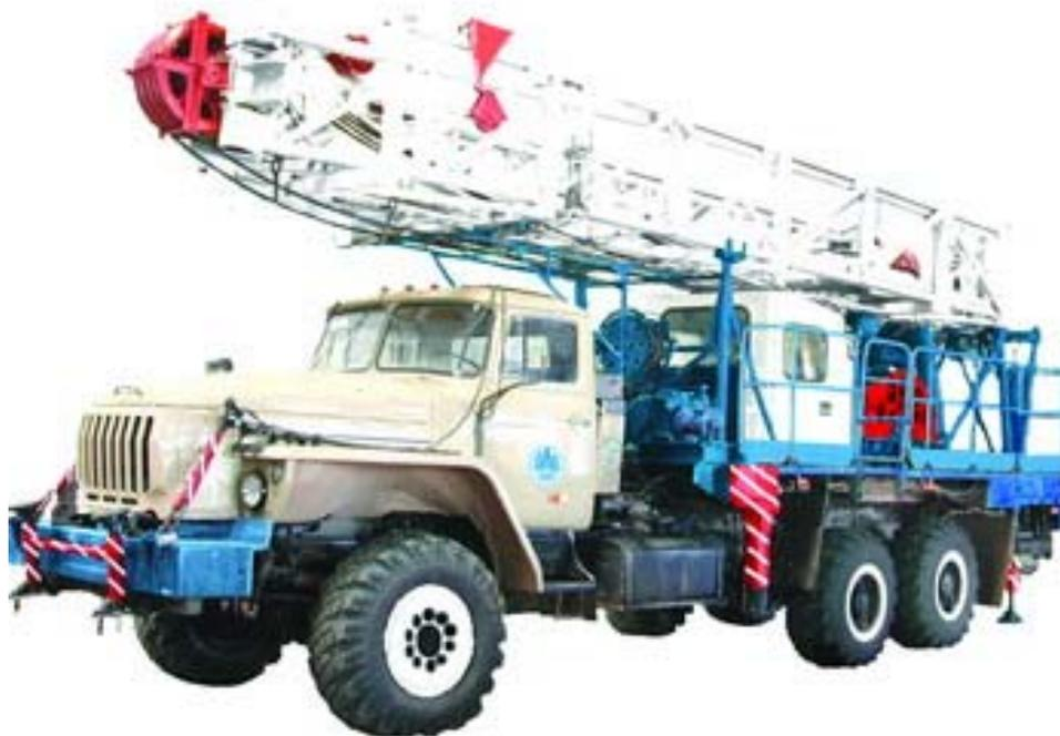
Рис. 2.46. Агрегат подъемный для ремонта скважин АПРС-40М
