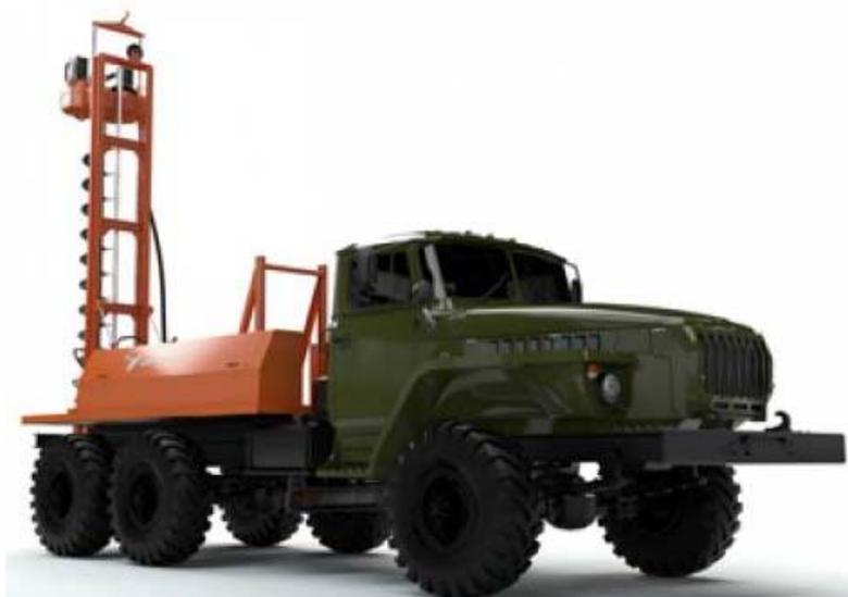
Рис. 2.125. Общий вид установки ПБУ-2
