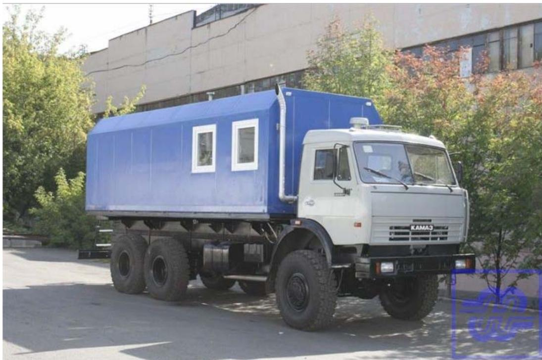
Рис. 2.54. Общий вид паропромысловой установки ППУ 1900/100
