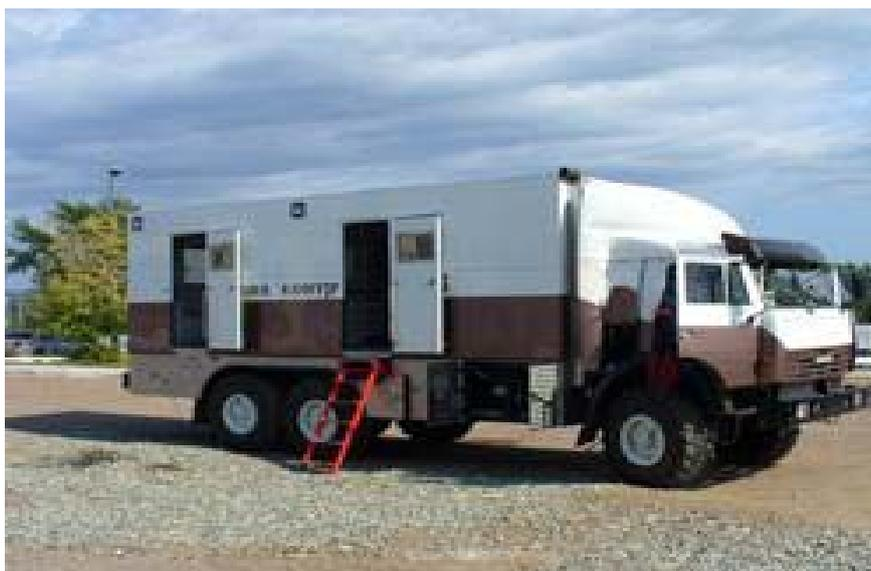
Рис. 2.121. Станция контроля гидроразрыва пласта (ГРП)
