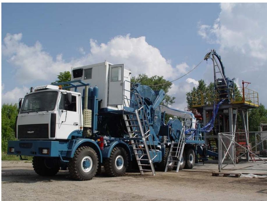
Рис. 2.68. Общий вид колтюбинговой установки МК30Т-10
