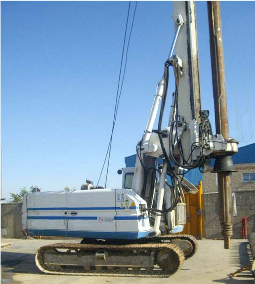
Рис. 2.127. Общий вид буровой установки на гусеничном ходу R-208 HD
