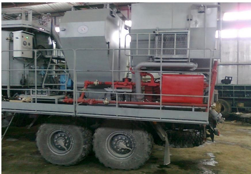
Рис. 2.115. Станция СКЦ «Раствор-М», установленная стационарно на раме насосной установки (шасси автомобиля КамАЗ)
