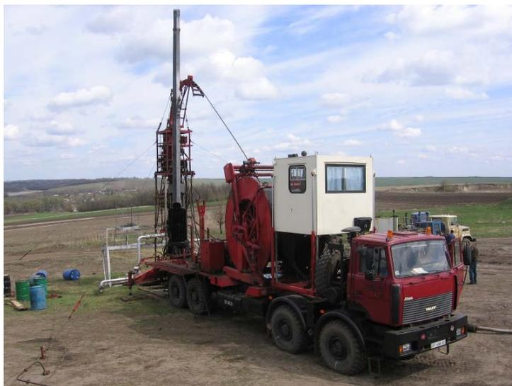
Рис. 2.66. Общий вид колтюбинговой установки МК20Т-50
