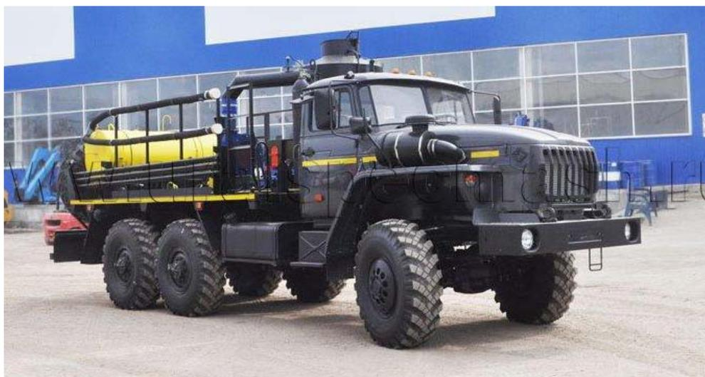
Рис. 2.60. Агрегат депарафинизации АДПМ-12/150
