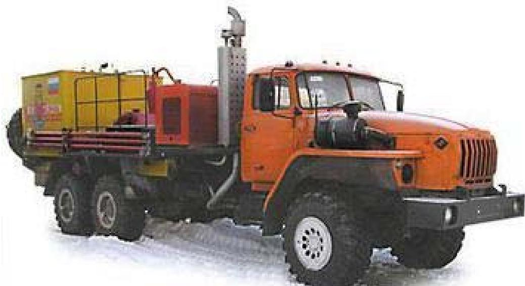
Рис. 2.1. Общий вид цементировочного агрегата ЦА-320
