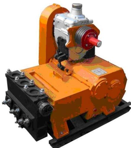
Рис. 2.95. Общий вид подпорного насоса НБ4-160/63
