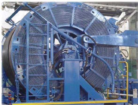
Рис. 2.72. Общий вид барабана намотки гибкой трубы
