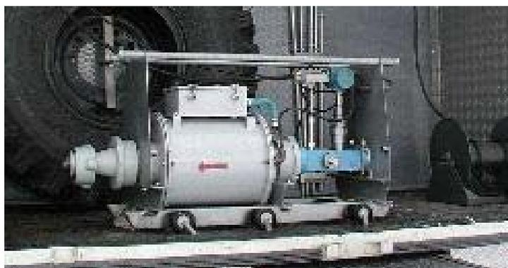
Рис. 2.113. Блок технологический ТЛБ-1 станции «КС-цемент»
