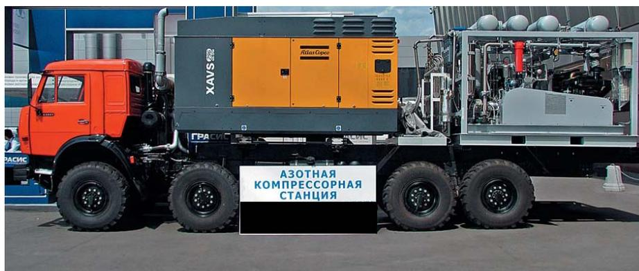
Рис. 2.101. Общий вид станции ПКСА-9/200
