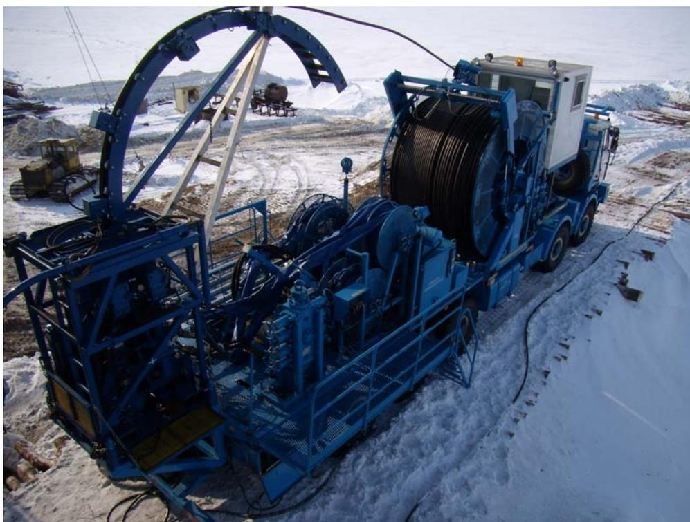
Рис. 2.69. Общий вид колтюбинговой установки МК30Т-20
