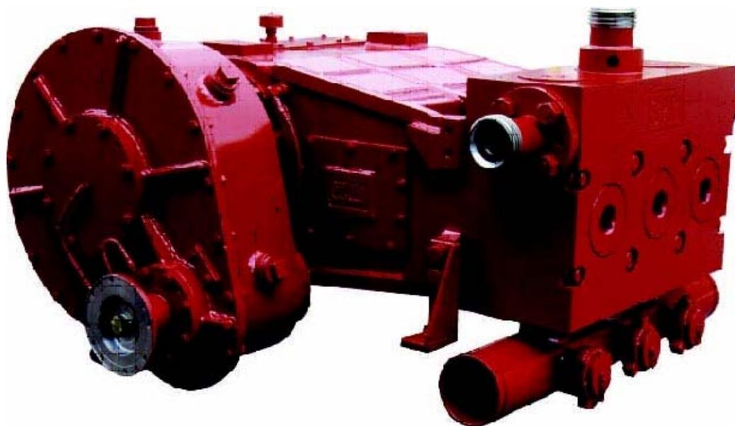
Рис. 2.106. Трехплунжерный насос SPM TWS600S
