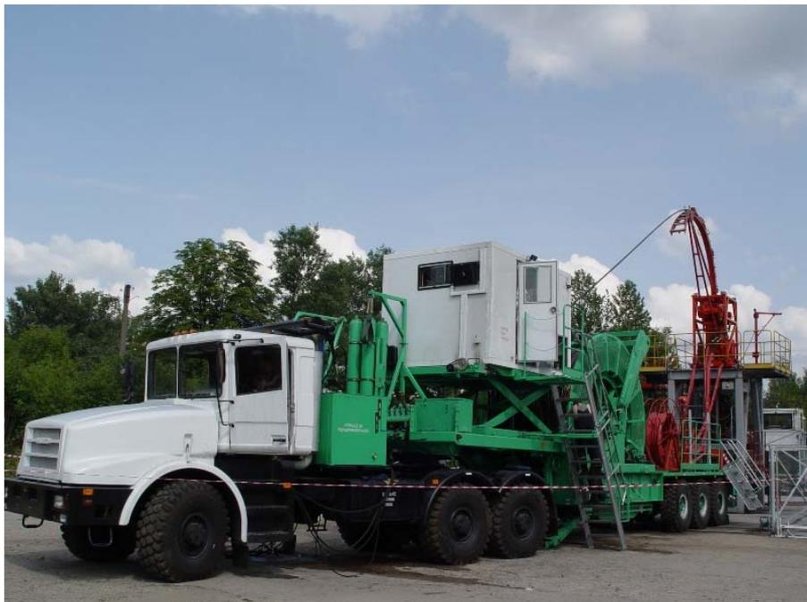
Рис. 2.67. Общий вид колтюбинговой установки МК30Т
