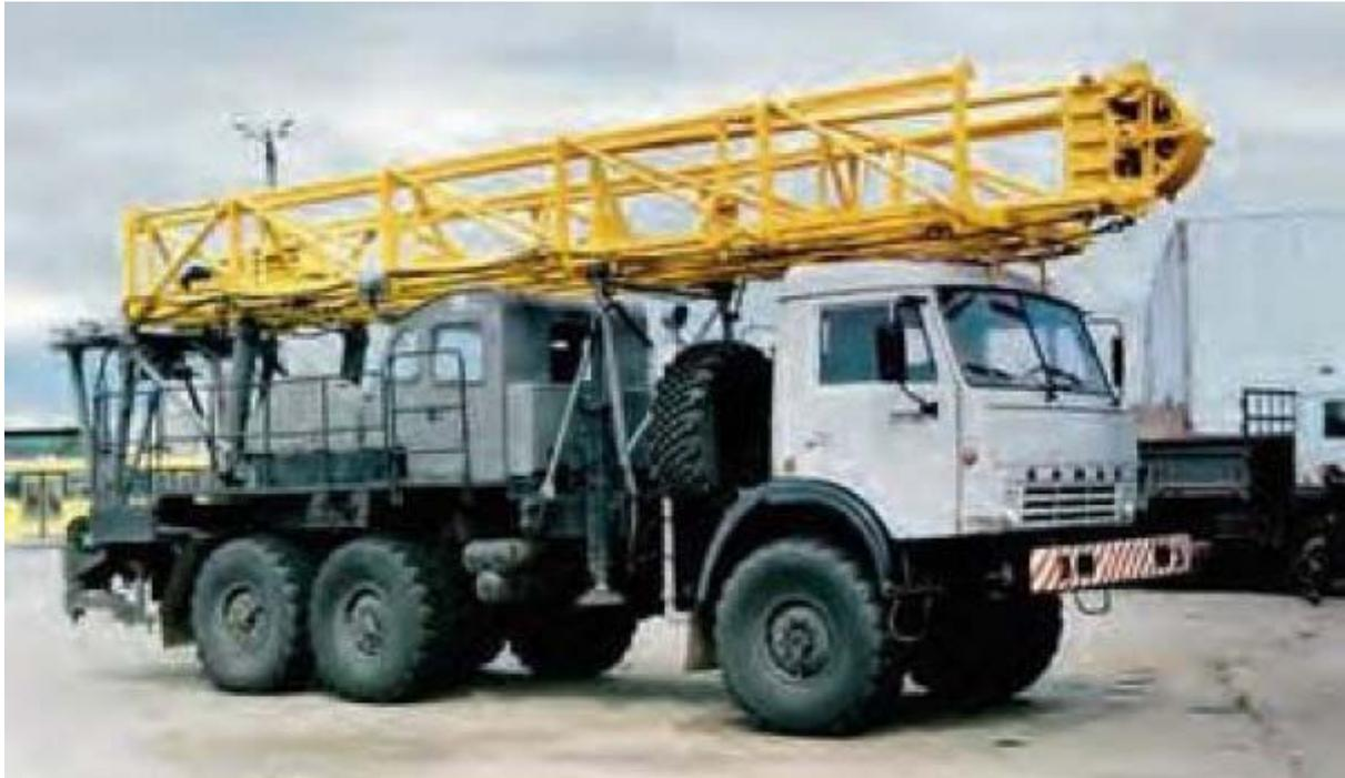
Рис. 2.47. Агрегат АПРС-40К на шасси КамАЗ
