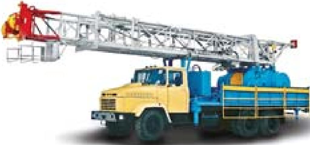
Рис. 2.48. Агрегат ремонтный АР-60
