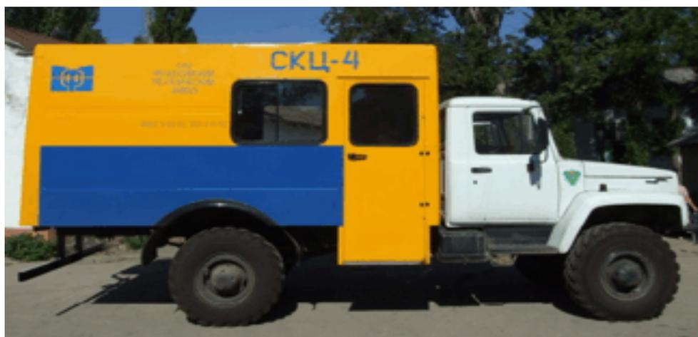
Рис. 2.107. Лабораторный блок станции контроля цементирования СКЦ-4
