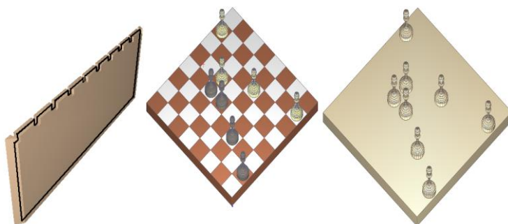
Рис. 9.6 Построение пластин из произвольных геометрических форм с распознаванием серединной поверхности – слева и без – справа
