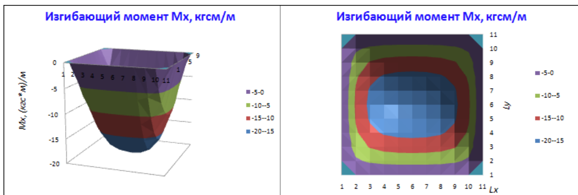
Рис.3.9. Эюра изгибающего момента M_x
