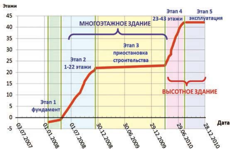
Рис. 5. График строительства жилого дома, ул. Дыбенко, д. 38
