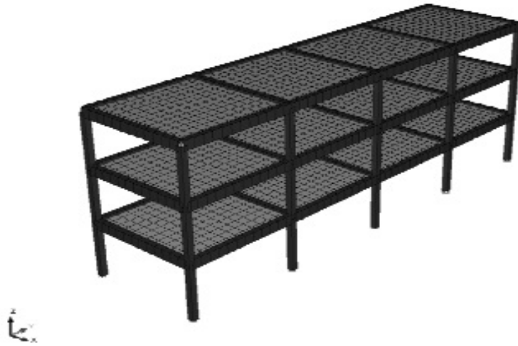
Рис. 3.11 - Расчетная конечно-элементная модель здания
