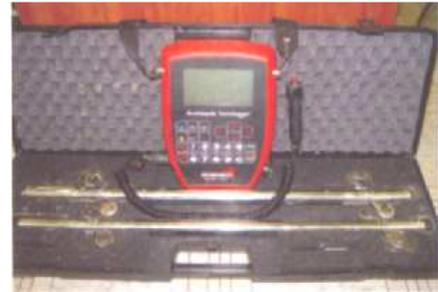
Рис.10.5. Общий вид инклинометра фирмы SISGEO (пример отечественного применения)
