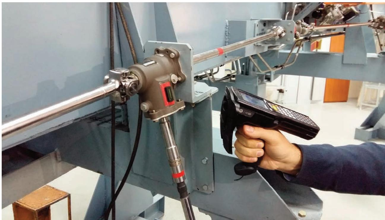
Считывание информации с радиочастотной метки ручным ридером, ОАК (Фото: Марина Лысцева)
