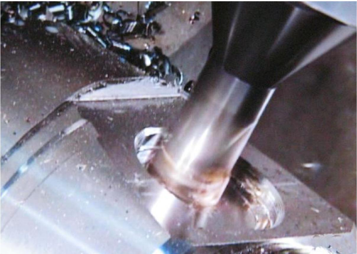
Рис. 63. Растачивание фрезерованием цилиндрического отверстия перпендикулярно наклонной (к продольной оси детали) поверхности
