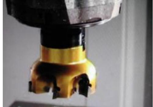
Рис. 48. Торцовая фреза со вставками из сверхтвердых материалов
