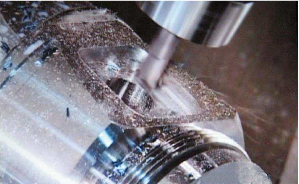
Рис. 60. Фрезерование полостей квадратных, прямоугольных
