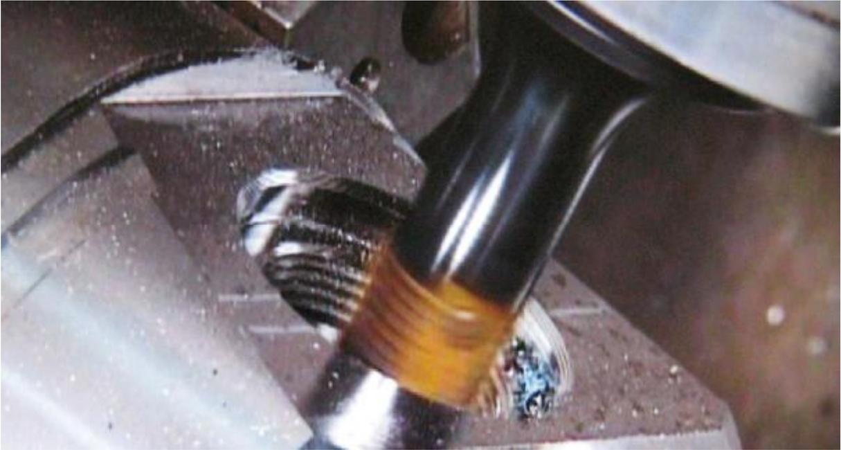
Рис. 62. Нарезание вихревым фрезерованием резьбы на поверхности цилиндрического отверстия
