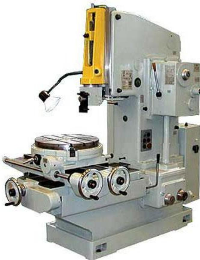
Рис. 69. Станок долбежный одностоечный
