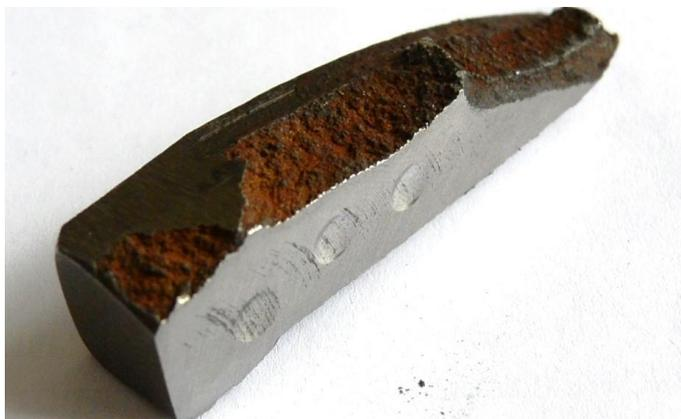
Фото 4 – Образец материала ступицы для исследования
