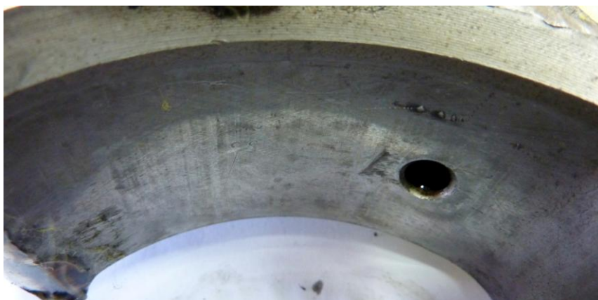
Фото 6 - Состояние рабочей поверхности нижней головки шатуна
