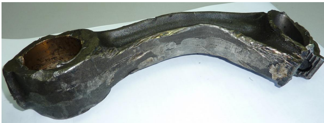
Фото 3 – Поврежденный шатун двигателя ЯМЗ-236
