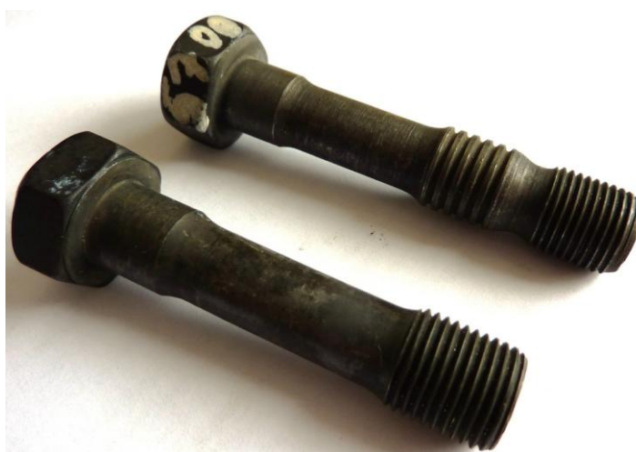
Фото 2 – Новые шатунные болты, представленные на исследование
