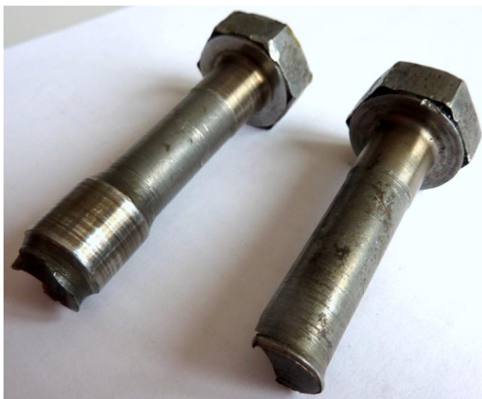
Фото 1 – Фрагменты шатунных болтов, представленных на исследование
