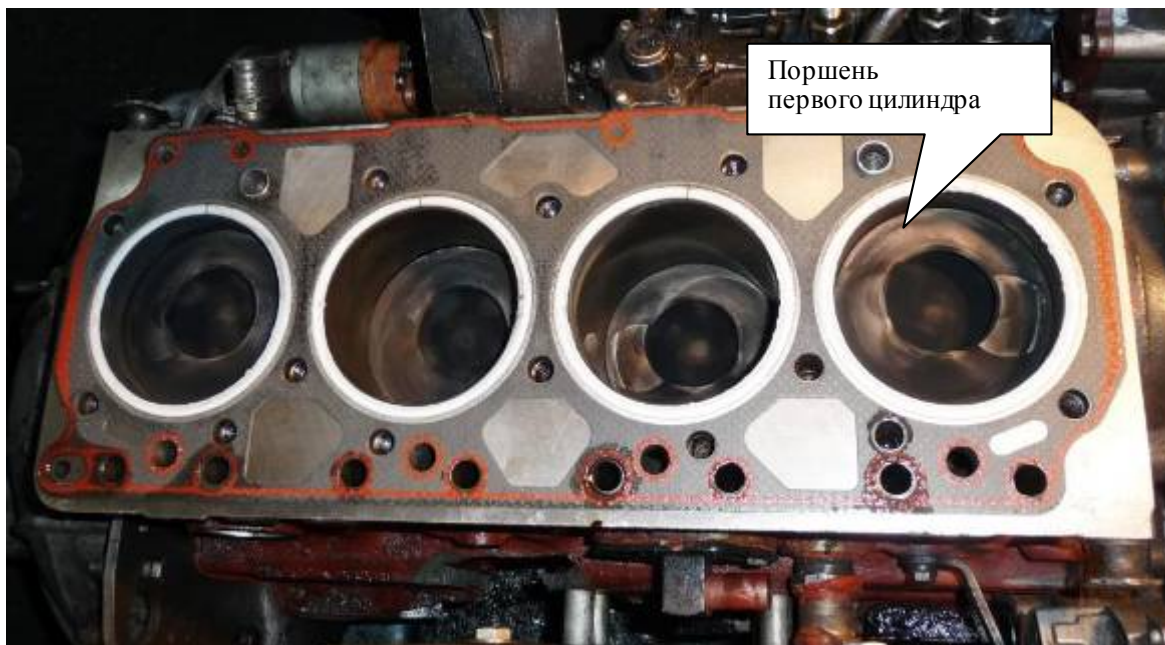
Фото 17. Поршни со следами от соприкосновения с тарелками клапанов
