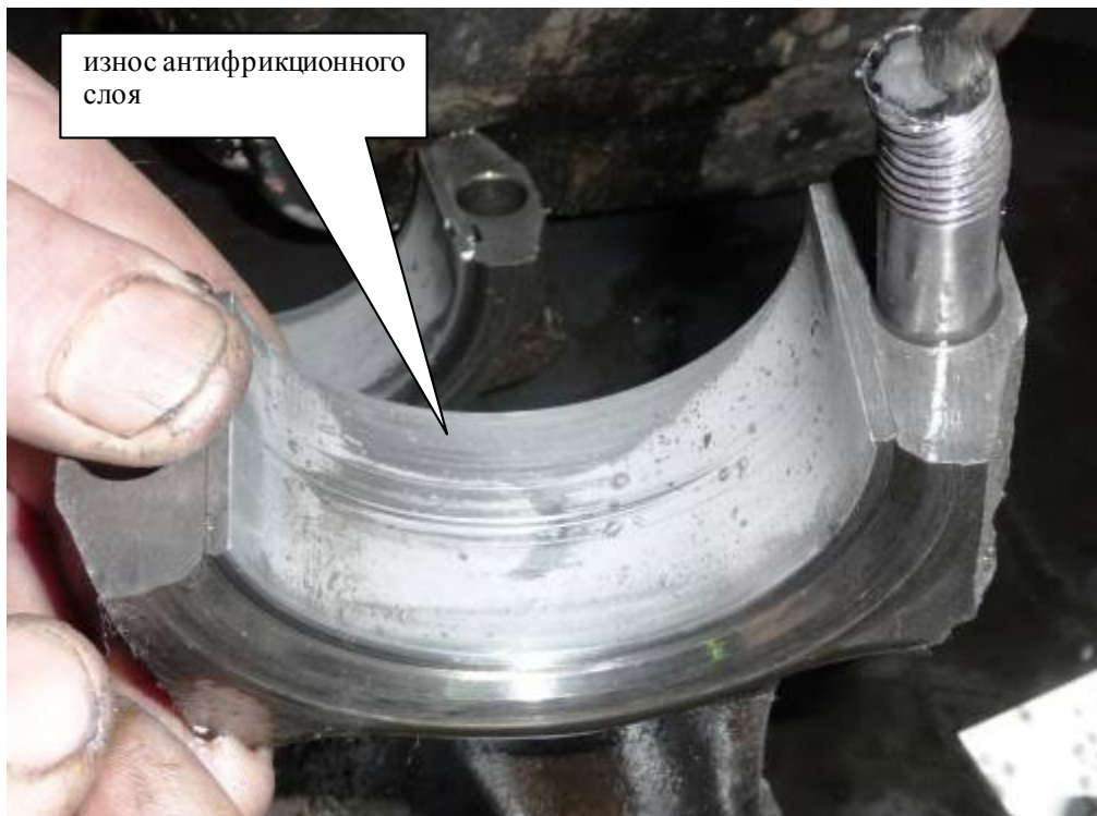
Фото 16. Состояние антифрикционного слоя верхнего шатунного вкладыша 3-го цилиндра
