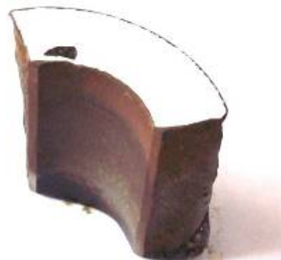
Фото 30. Фрагмент пальца после микрошлифа
