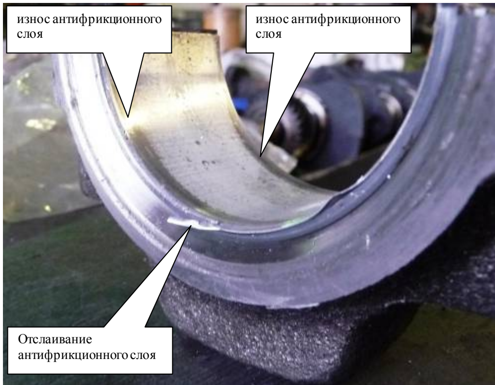
Фото 15. Повреждение антифрикционного слоя нижнего шатунного вкладыша 3-го цилиндра
