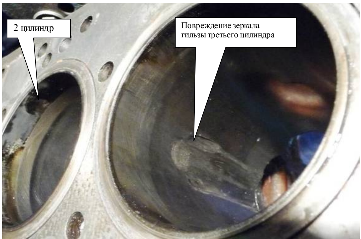
Фото 12. Повреждение рабочей поверхности гильзы третьего цилиндра со стороны второго цилиндра
