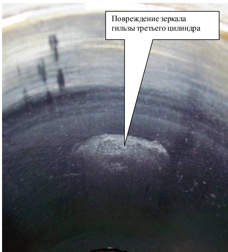
Фото 14. Повреждение рабочей поверхности гильзы третьего цилиндра со стороны четвёртого цилиндра
