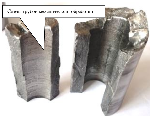
Фото 29. Фрагмент пальца до микрошлифа
