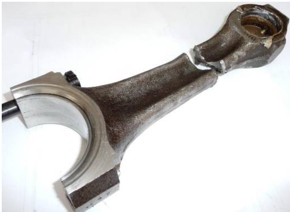
Фото 5. Разрушенный шатун третьего цилиндра
