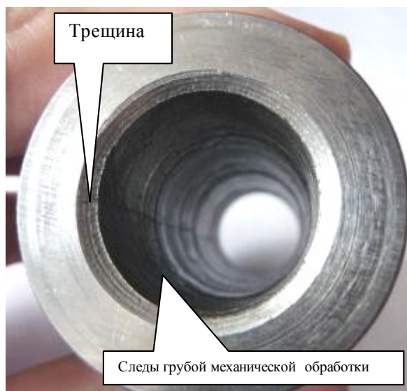
Фото 8. Продольные трещины на поршневых пальцах
