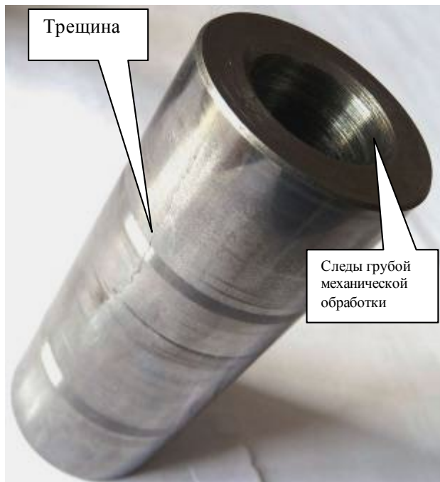
Фото 8. Продольные трещины на поршневых пальцах
