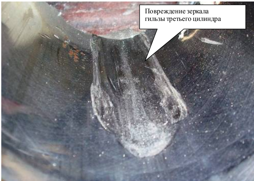
Фото 13. Повреждение рабочей поверхности гильзы третьего цилиндра со стороны второго цилиндра
